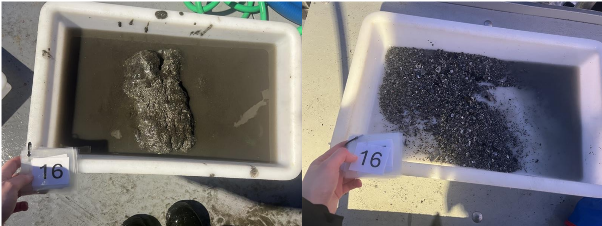
Figur 16: Bilder som viser sedimentet fra stasjon 16 før og etter siling. Sedimentet besto av leire, silt og skjellsand. Foto: Aqua Kompetanse AS.
