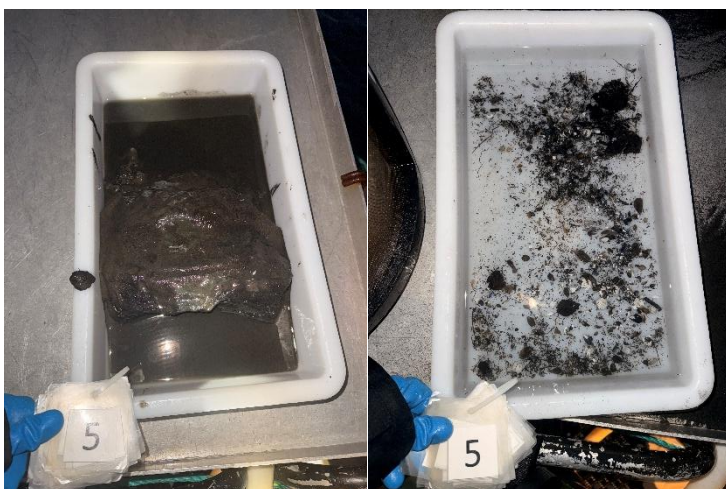
Figur 5: Bilder som viser sedimentet fra stasjon 5 før og etter siling. Sedimentet besto av silt, grus og skjellsand. Foto: Aqua Kompetanse AS.
