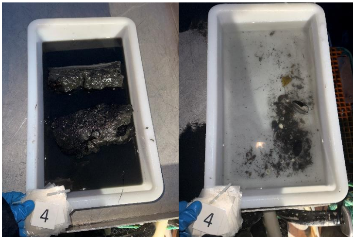
Figur 4: Bilder som viser sedimentet fra stasjon 4 før og etter siling. Sedimentet besto av skjellsand og silt. Det ble registrert rester av fekalier ved stasjonen. Foto: Aqua Kompetanse AS.
