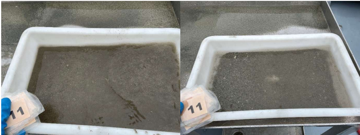
Figur 11: Bilder som viser sedimentet fra stasjon 11 før og etter siling. Sedimentet besto av skjellsand og sand. Det ble registrert fekalierester ved stasjonen. Foto: Aqua Kompetanse AS.
