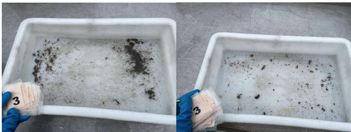
Figur 3: Bilder som viser sedimentet fra stasjon 3 før og etter siling. Sedimentet besto av strø av silt på fjellbunn. Foto: Aqua Kompetanse AS.
