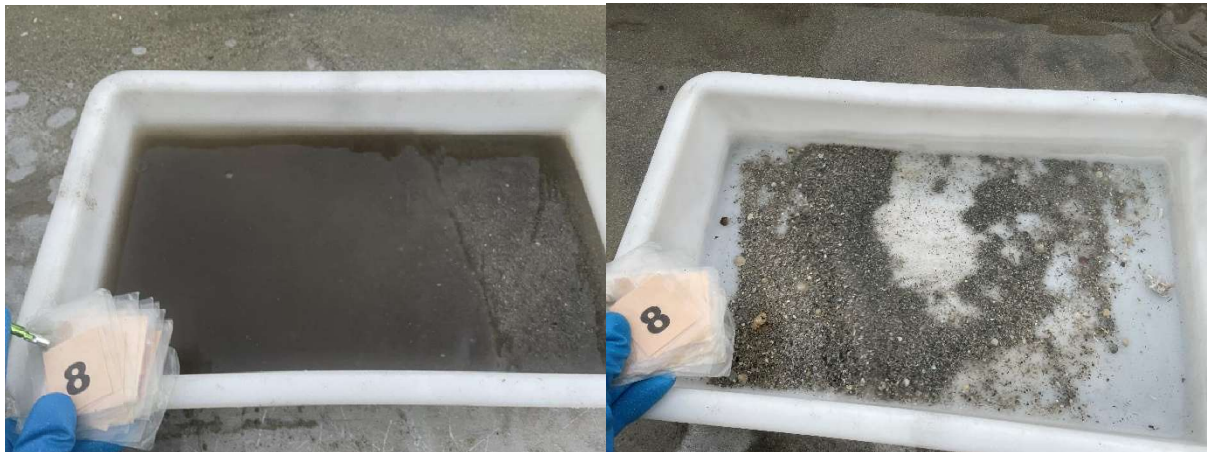
Figur 8: Bilder som viser sedimentet fra stasjon 8 før og etter siling. Sedimentet besto av skjellsand, sand og silt. Foto: Aqua Kompetanse AS.
