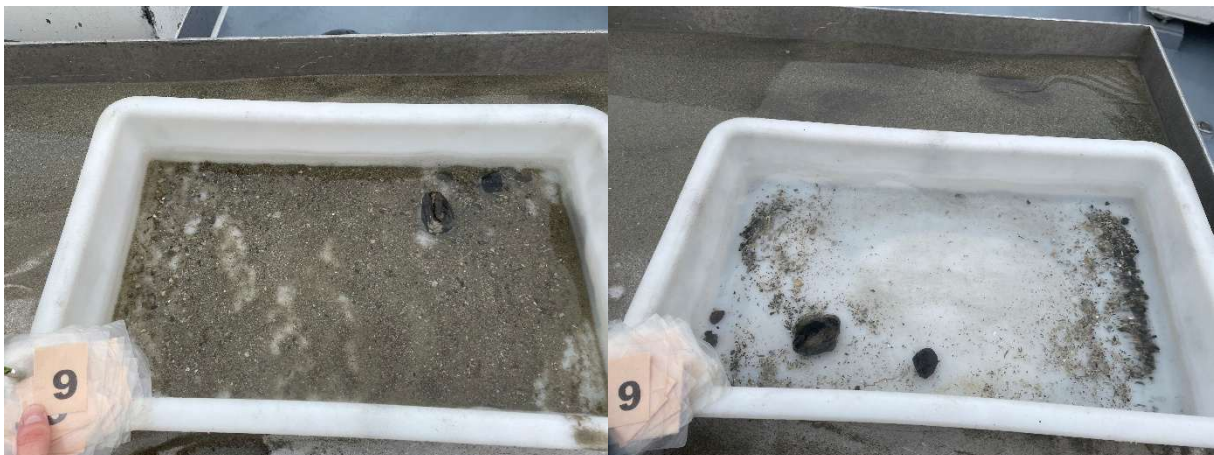
Figur 9: Bilder som viser sedimentet fra stasjon 9 før og etter siling. Sedimentet besto av strø av skjellsand på fjell- og steinbunn. Foto: Aqua Kompetanse AS.
