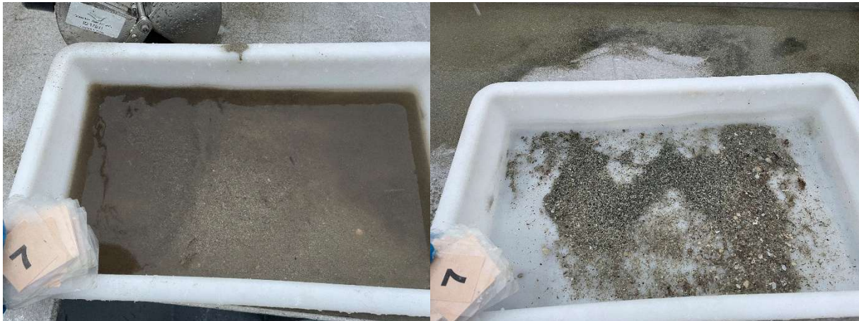
Figur 7: Bilder som viser sedimentet fra stasjon 7 før og etter siling. Sedimentet besto av skjellsand og silt. Det ble registrert fekalierester ved stasjonen. Foto: Aqua Kompetanse AS.
