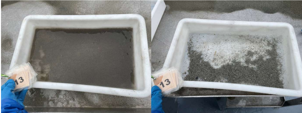
Figur 13: Bilder som viser sedimentet fra stasjon 13 før og etter siling. Sedimentet besto av fjellbunn og skjellsand. Det ble registrert fekalierester ved stasjonen. Foto: Aqua Kompetanse AS.
