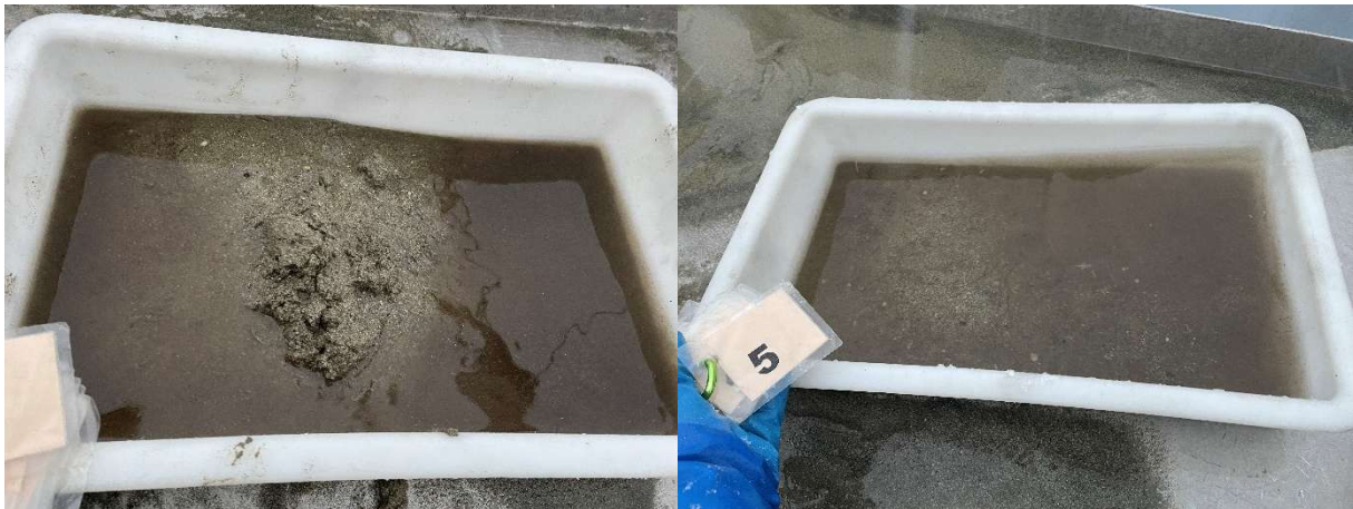
Figur 5: Bilder som viser sedimentet fra stasjon 5 før og etter siling. Sedimentet besto av skjellsand og sand. Foto: Aqua Kompetanse AS.
