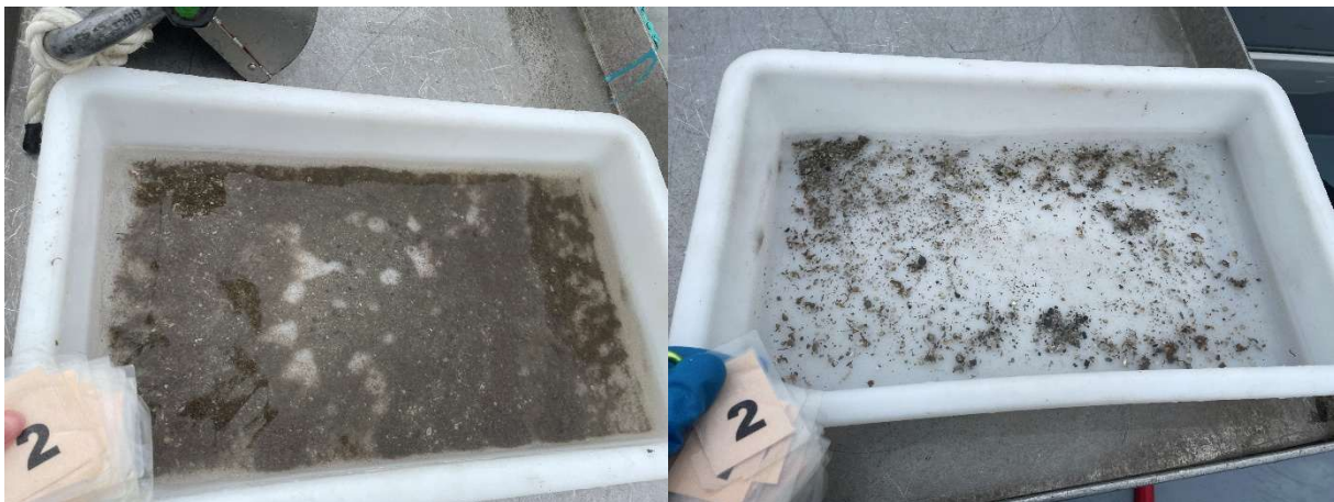
Figur 2: Bilder som viser sedimentet fra stasjon 2 før og etter siling. Sedimentet besto av strø av silt og skjellsand på fjellbunn. Foto: Aqua Kompetanse AS.
