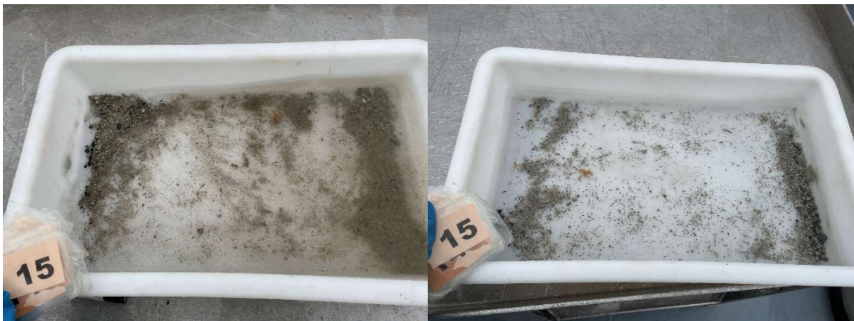
Figur 15: Bilder som viser sedimentet fra stasjon 15 før og etter siling. Sedimentet besto av strø av skjellsand på fjellbunn. Det ble registrert fekalierester ved stasjonen. Foto: Aqua Kompetanse AS.
