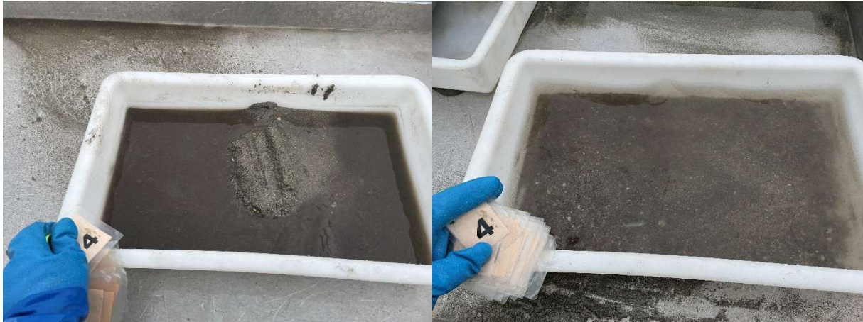
Figur 4: Bilder som viser sedimentet fra stasjon 4 før og etter siling. Sedimentet besto av skjellsand, sand og silt. Foto: Aqua Kompetanse AS.
