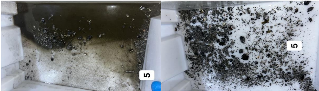
Figur B.5: Bilder før og etter siling ved stasjon 5. Sedimentet besto av silt, sand og grus.
