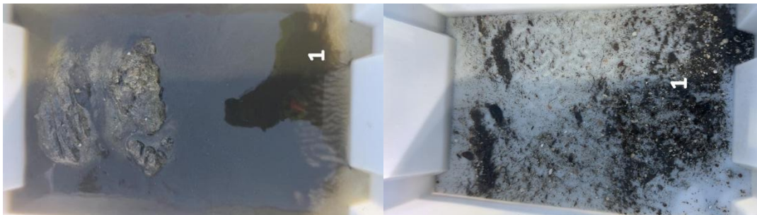
Figur B.1: Bilder før og etter siling ved stasjon 1. Sedimentet besto av silt og sand.
