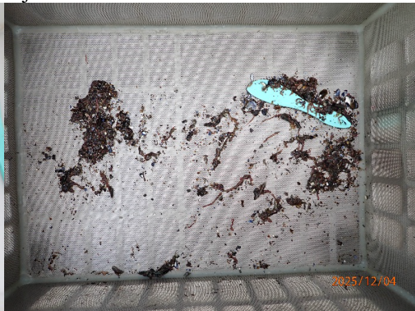
Prøvestasjon 7: Silt. Grå og luktfri prøve med mjuk konsistens.
