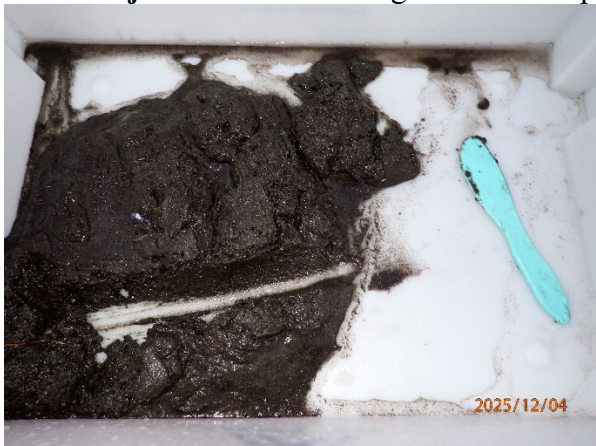
Prøvestasjon 4: Silt. Mørk farge men luktfri prøve med mjuk konsistens.
