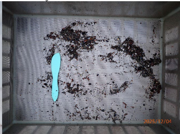
Prøvestasjon 4: Silt. Mørk farge men luktfri prøve med mjuk konsistens.
