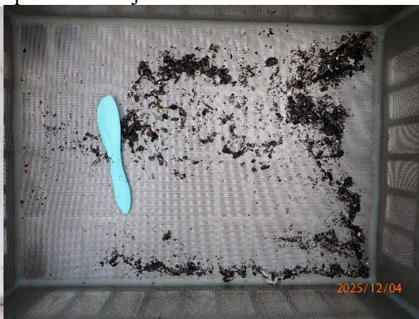
Prøvestasjon 5: Silt. Mørk farge og noko lukt i prøve med mjuk konsistens.
