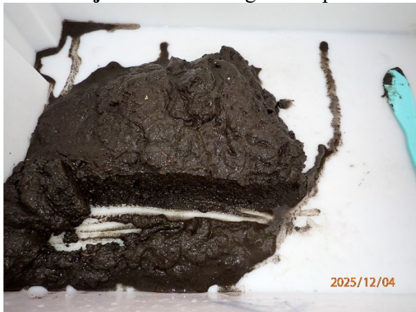
Prøvestasjon 7: Silt. Grå og luktfri prøve med mjuk konsistens.
