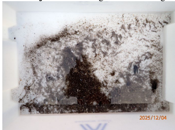
Prøvestasjon 9: Litt silt og sand. Mørk farge men luktfri prøve med fast konsistens.
