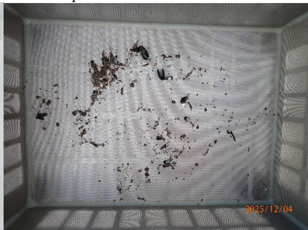
Prøvestasjon 9: Litt silt og sand. Mørk farge men luktfri prøve med fast konsistens.
