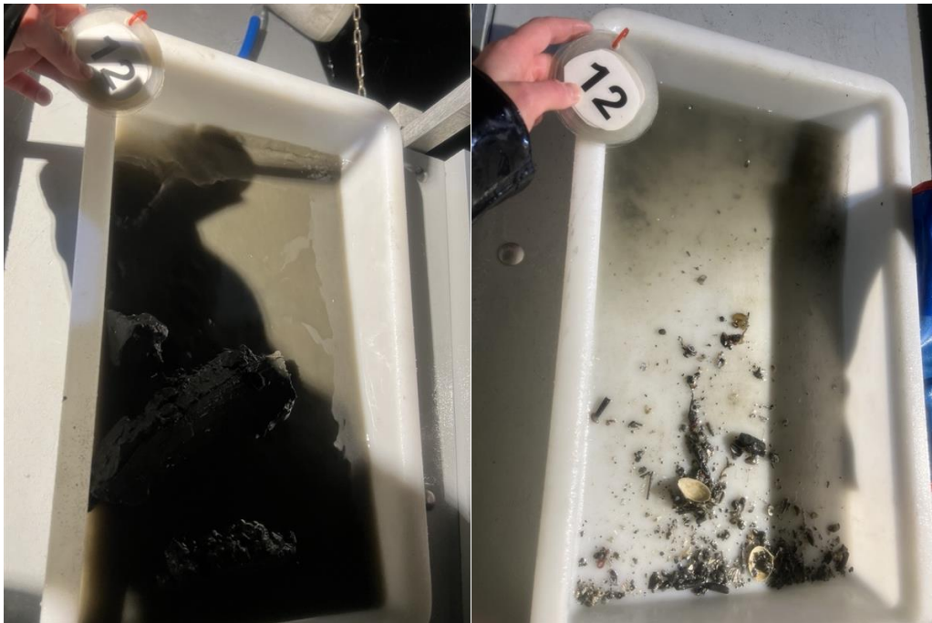
Figur 10: Bildet som viser sedimentet fra stasjon 12 før og etter siling. Sedimentet besto av leire, silt og sand. Foto: Aqua Kompetanse AS.
