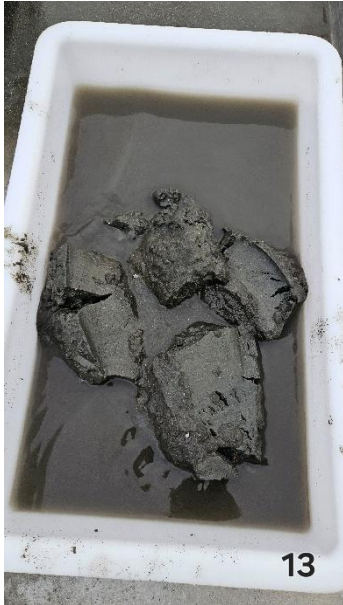
Figur 13: Bilde som viser sedimentet fra stasjon 13 før siling. Sedimentet besto silt og skjellsand. Bilde etter siling ble avglemt i felt. Foto: Aqua Kompetanse AS.
