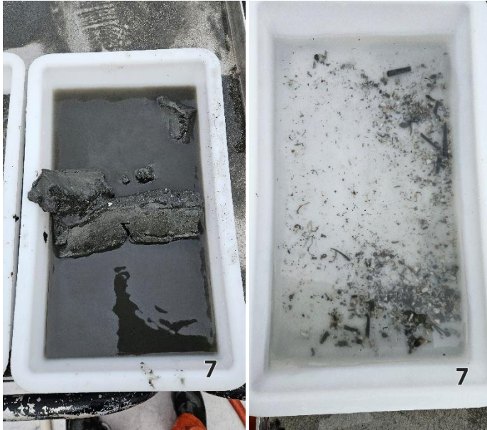
Figur 7: Bilder som viser sedimentet fra stasjon 7 før og etter siling. Sedimentet besto av leire, silt og skjellsand. Foto: Aqua Kompetanse AS.
