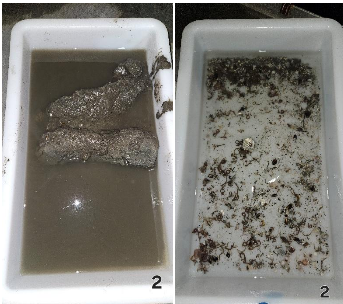
Figur 2: Bilder som viser sedimentet fra stasjon 2 før og etter siling. Sedimentet besto av silt og skjellsand. Foto: Aqua Kompetanse AS.
