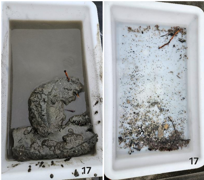
Figur 17: Bilder som viser sedimentet fra stasjon 17 før og etter siling. Sedimentet besto av silt og skjellsand. Foto: Aqua Kompetanse AS.
