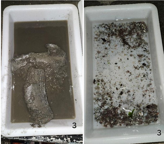
Figur 3: Bilder som viser sedimentet fra stasjon 3 før og etter siling. Sedimentet besto av silt og skjellsand. Foto: Aqua Kompetanse AS.
