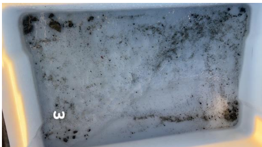
Figur B.3: Bilde av sedimentet ved stasjon 3. Sedimentet besto av grus på fjellbunn.
