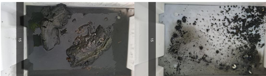
Figur B. 15: Bilde før og etter siling ved stasjon 15. Sedimentet besto av leire og silt.
