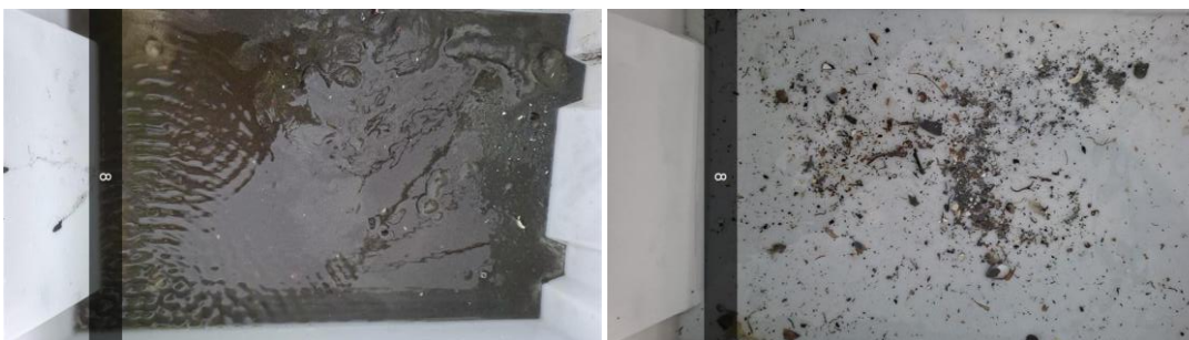
Figur B.8: Bilder før og etter siling ved stasjon 8. Sedimentet besto av leire ispedd litt sand og grus.
