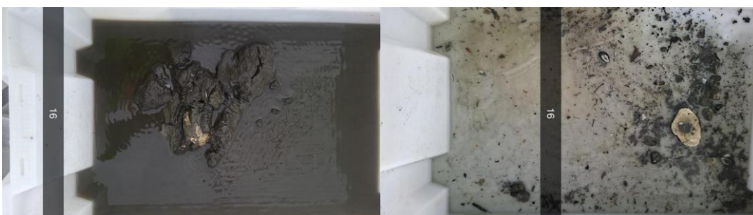
Figur B. 16: Bilder før og etter siling ved stasjon 16. Sedimentet er besto av silt og leire.
