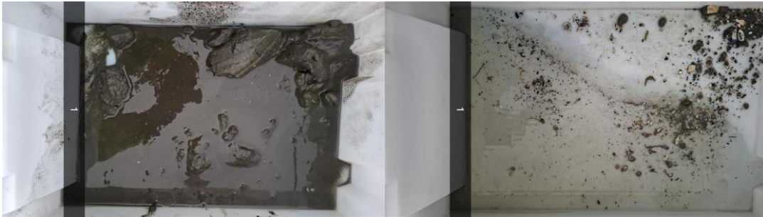
Figur B.1: Bilder før og etter siling ved stasjon 1. Sedimentet besto av silt og leire.
