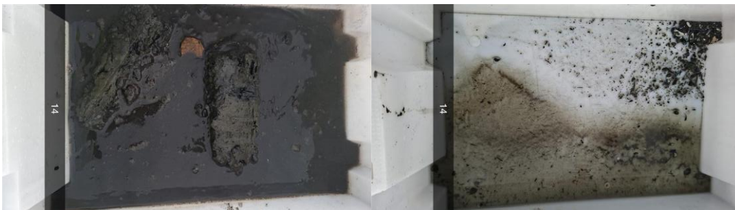
Figur B. 14: Bilder før og etter siling ved stasjon 14. Sedimentet besto av silt og leire.
