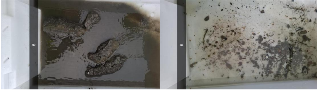
Figur B.9: Bilder før og etter siling ved stasjon 9. Sedimentet besto av leire, silt, og litt grus.
