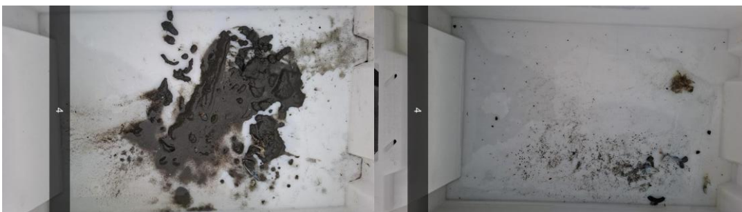
Figur B.4: Bilder før og etter siling ved stasjon 4. Sedimentet besto av silt og grus på steinbunn.
