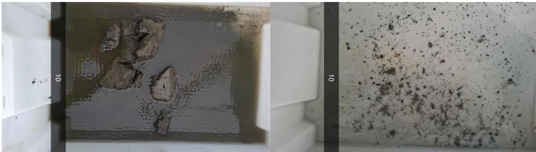
Figur B.10: Bilder før og etter siling ved stasjon 10. Sedimentet besto av leire og litt silt.
