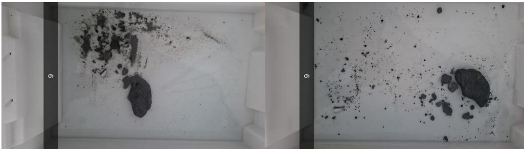
Figur B.6: Bilder før og etter siling ved stasjon 6. Sedimentet besto av grus på steinbunn.
