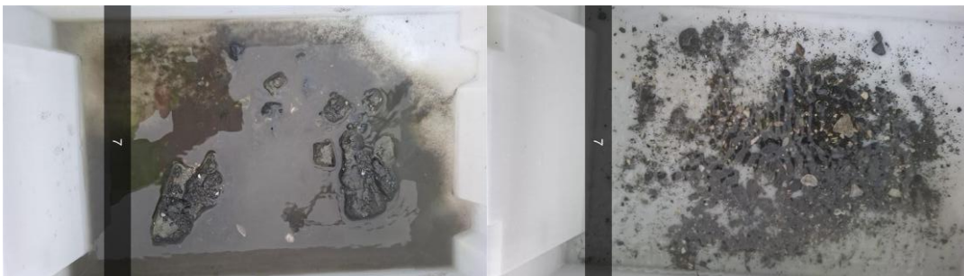
Figur B.7: Bilder før og etter siling ved stasjon 7. Sedimentet besto av leire, silt, og grus på steinbunn.
