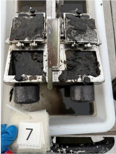
Figur 7: Bilde som viser sedimentet fra stasjon 7. Sedimentet besto av strø av silt og leire. Det ble registrert fekalier ved stasjonen. Foto: Aqua Kompetanse AS.
