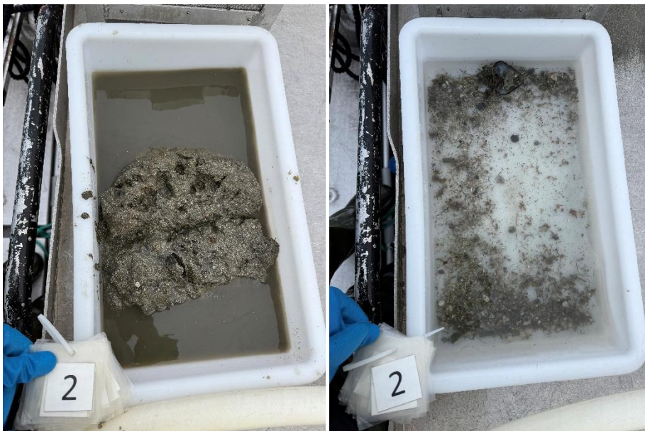
Figur 2: Bilder som viser sedimentet fra stasjon 2 før og etter siling. Sedimentet besto av silt, grus og skjellsand. Foto: Aqua Kompetanse AS.
