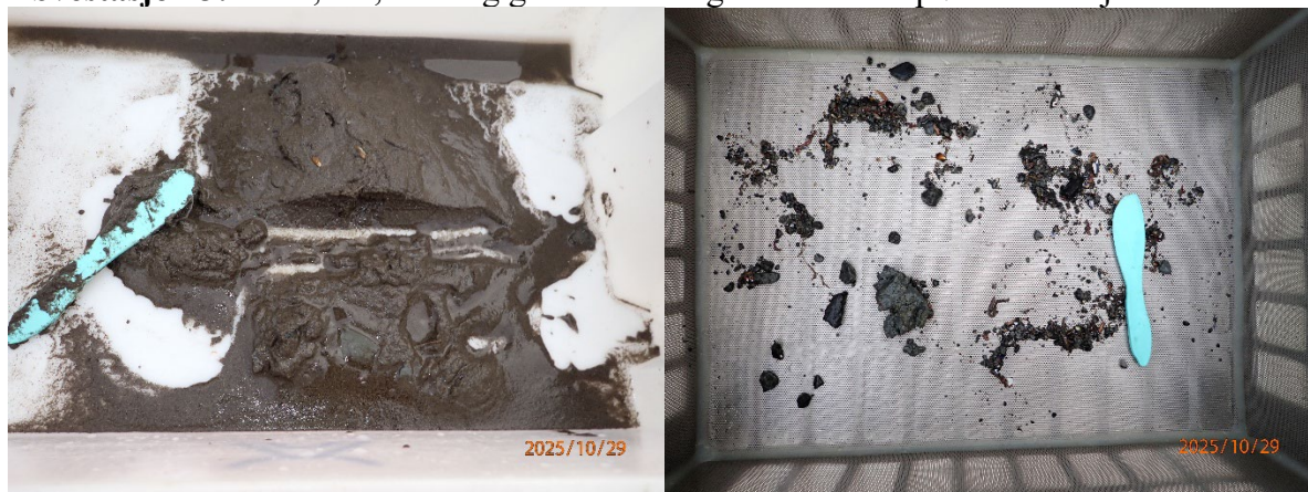
Prøvestasjon 3: Leire, silt, sand og grus. Brun farge men luktfri prøve med mjuk konsistens.
