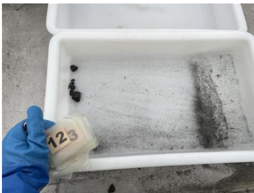
Figur 12: Bilde som viser grabbprøve fra stasjon 12. Det ble registrert grus, skjellsand og fjellbunn. Foto: Aqua Kompetanse AS.
