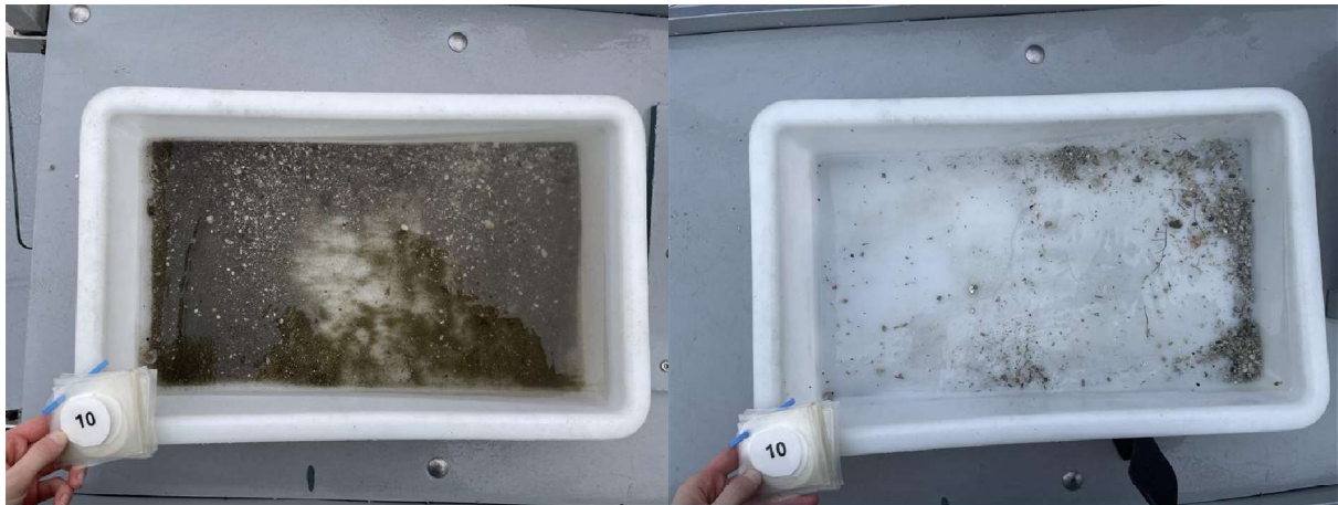
Figur 10: Bilder som viser sedimentet fra stasjon 10 før og etter siling. Sedimentet besto av silt, sand og skjellsand. Det ble også registrert fjellbunn ved stasjonen. Det ble observert fekalier ved stasjonen. Foto: Aqua Kompetanse AS.
