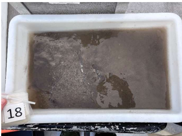
Figur 18: Bilde som viser sedimentet fra stasjon 18. Sedimentet besto av skjellsand og sand. Foto: Aqua Kompetanse AS.
