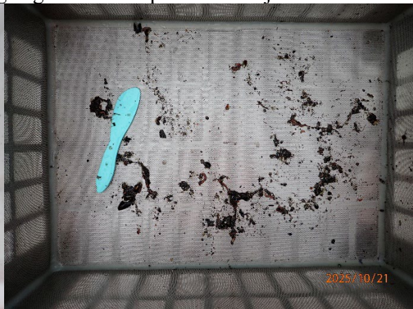
Prøvestasjon 5: Silt med fiske-skit. Mørk farge og noko lukt i prøve med mjuk konsistens.
