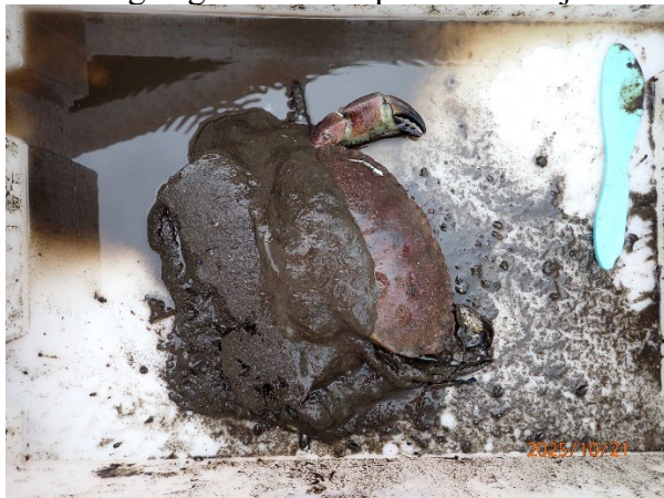
Prøvestasjon 6: Silt med fiske-skit, og ein død taske-grabbe. Mørk farge og sterk lukt i prøve med mjuk konsistens.
