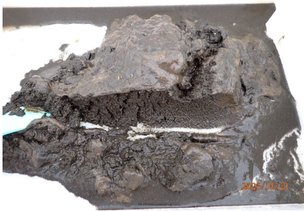
Prøvestasjon 5: Silt med fiske-skit. Mørk farge og noko lukt i prøve med mjuk konsistens.
