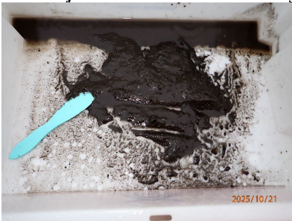
Prøvestasjon 5: Silt med fiske-skit. Mørk farge og noko lukt i prøve med mjuk konsistens.
