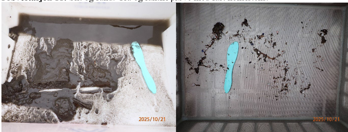
Prøvestasjon 11: Silt og sand. Grå og luktfri prøve med fast konsistens.
