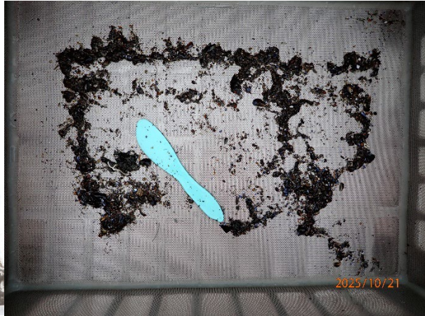
Prøvestasjon 4: Silt med fiske-skit. Brun farge og noko lukt i prøve med mjuk konsistens.
