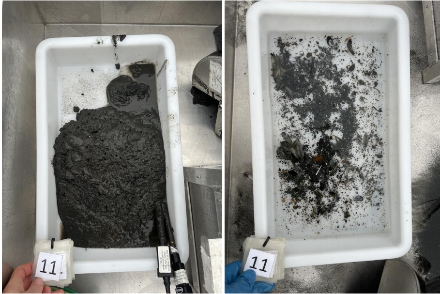
Figur 11: Bilde som viser sedimentet fra stasjon 11 før og etter siling. Sedimentet besto av silt og noe grus. Foto: Aqua Kompetanse AS.
