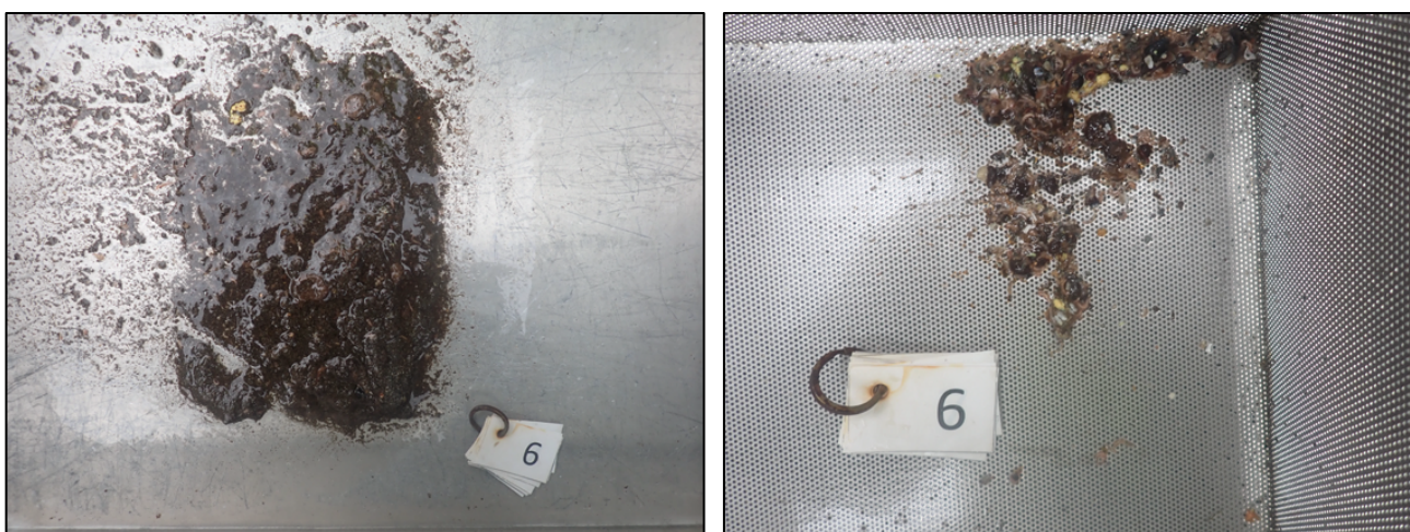
Figur 12. Bilder av sedimentet hentet opp fra prøvepunkt 6. Uvasket prøve til venstre og vasket/silt prøve til høyre.
