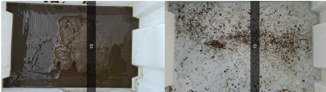
Figur B.10: Bilder før og etter siling ved stasjon 10. Sedimentet besto av silt og skjellsand.
