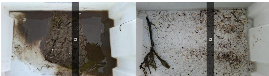
Figur B.12: Bilder før og etter siling ved stasjon 12. Sedimentet besto av silt og skjellsand.
