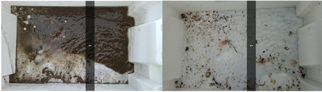
Figur B.1: Bilder før og etter siling ved stasjon 1. Sedimentet besto av silt, sand og skjellsand.
