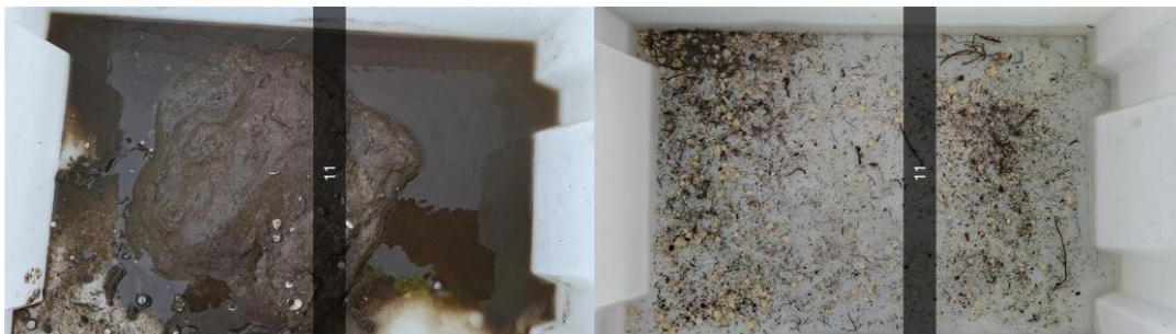
Figur B.11: Bilder før og etter siling ved stasjon 11. Sedimentet besto av silt.
