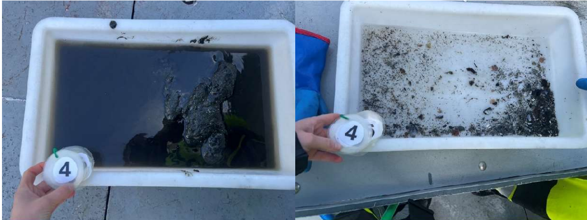
Figur 4: Bilder som viser sedimentet fra stasjon 4 før og etter siling. Sedimentet besto av silt, leire, sand og grus. Foto: Aqua Kompetanse AS.
