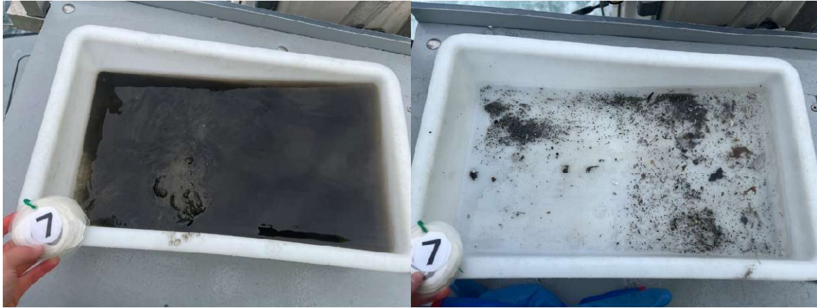
Figur 7: Bilder som viser sedimentet fra stasjon 7 før og etter siling. Sedimentet besto av silt og noe sand. Foto: Aqua Kompetanse AS.
