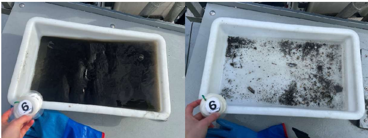
Figur 6: Bilder som viser sedimentet fra stasjon 6 før og etter siling. Sedimentet besto av silt, og noe grus og sand. Foto: Aqua Kompetanse AS.
