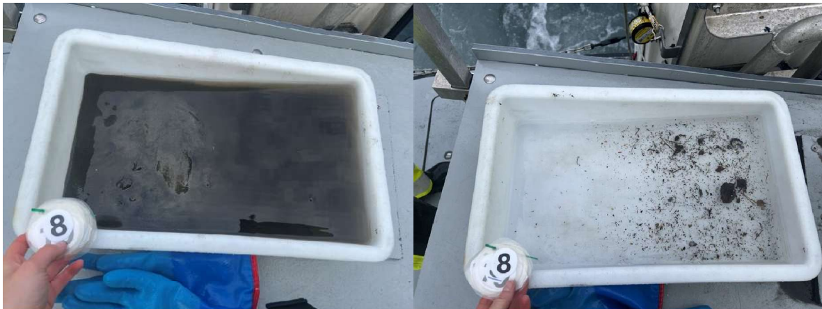
Figur 8: Bilder som viser sedimentet fra stasjon 8 før og etter siling. Sedimentet besto av silt og sand. Foto: Aqua Kompetanse AS.
