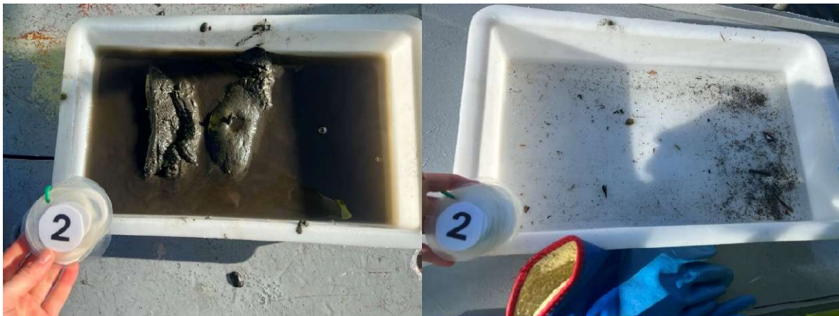
Figur 2: Bilder som viser sedimentet fra stasjon 2 før og etter siling. Sedimentet besto av silt og sand. Foto: Aqua Kompetanse AS.
