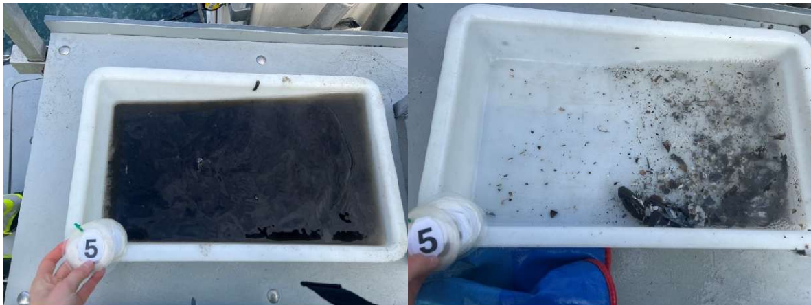
Figur 5: Bilder som viser sedimentet fra stasjon 5 før og etter siling. Sedimentet besto av silt og noe sand. Foto: Aqua Kompetanse AS.
