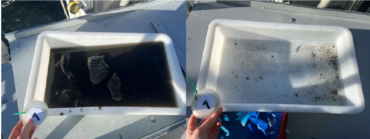
Figur 1: Bilder som viser sedimentet fra stasjon 1 før og etter siling. Sedimentet besto av leire og silt. Foto: Aqua Kompetanse AS.
