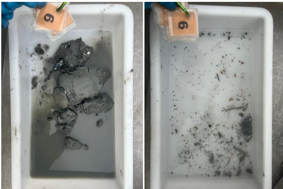
Figur 6: Bilder som viser sedimentet fra stasjon 6 før og etter siling. Sedimentet besto av leire og noe skjellsand. Foto: Aqua Kompetanse AS.
