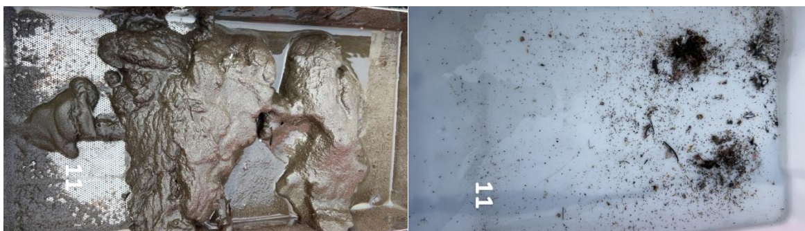
Figur B.11: Bilder før og etter siling ved stasjon 11. Sedimentet besto hovedsakelig av silt, men også litt sand.
