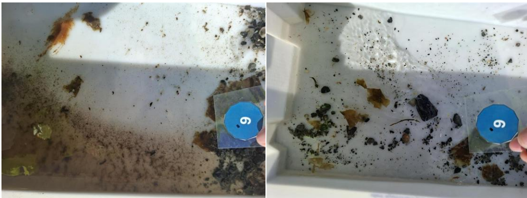
Figur B.6: Bilder før og etter siling ved stasjon 6. Sedimentet besto av grus, iblandet silt og skjellsand. Det ble registrert fekalier ved stasjonen.
