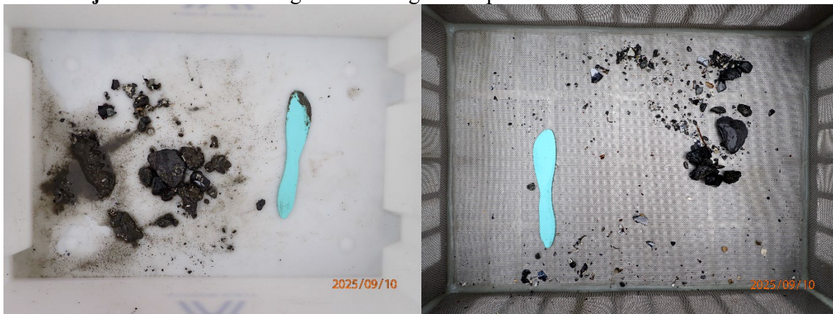
Prøvestasjon 4: Grus med silt og sand. Grå og luktfri prøve med fast konsistens.
