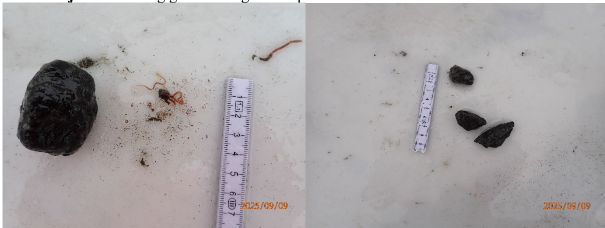
Prøvestasjon 5: Stein og grus. Grå og luktfri prøve med fast konsistens.
