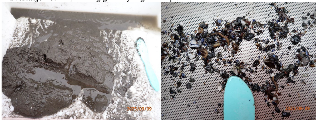
Prøvestasjon 8: Silt, sand og grus. Lys luktfri prøve med fast konsistens.
