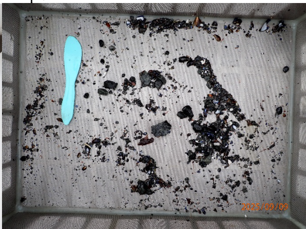
Prøvestasjon 14: Silt, sand og grus. Grå og luktfri prøve med fast konsistens.
