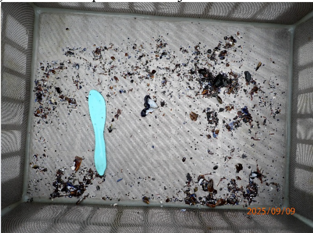
Prøvestasjon 15: Silt, sand og grus. Mørk farge men luktfri prøve med mjuk konsistens.
