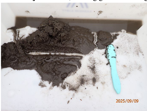
Prøvestasjon 15: Silt, sand og grus. Mørk farge men luktfri prøve med mjuk konsistens.
