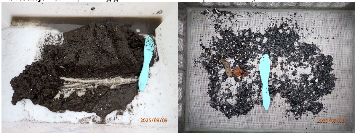
Prøvestasjon 6: Silt, sand og grus. Mørk men luktfri prøve med mjuk konsistens.
