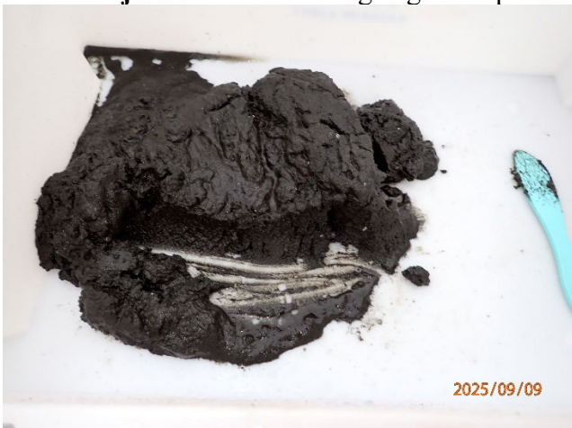
Prøvestasjon 9: Silt. Mørk farge og lukt i prøve med mjuk konsistens.
