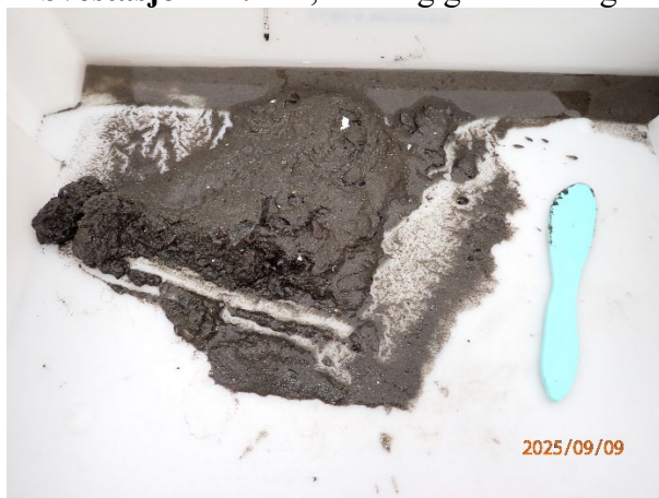
Prøvestasjon 14: Silt, sand og grus. Grå og luktfri prøve med fast konsistens.
