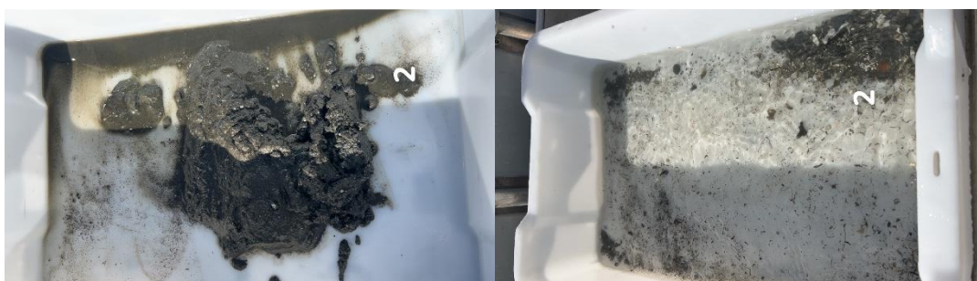
Figur B.2: Bilder før og etter siling ved stasjon 2. Sedimentet besto av sand, grus, og litt skjellsand.
