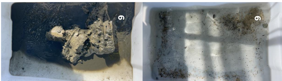
Figur B.9: Bilder før og etter siling ved stasjon 9. Sedimentet besto av sand, skjellsand, og litt silt.
