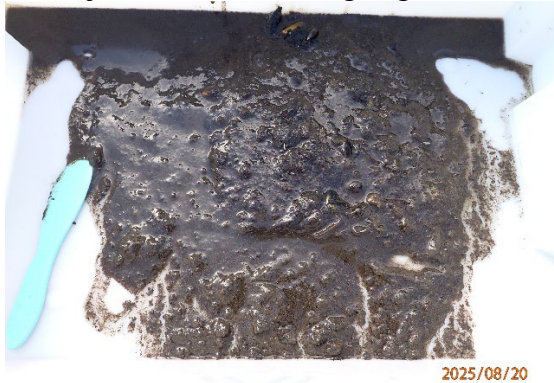
Prøvestasjon 8: Silt. Brun farge og noko lukt i prøve med mjuk konsistens.
