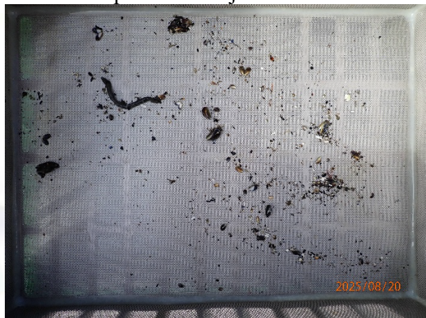
Prøvestasjon 7: Silt, sand og grus. Brun farge men luktfri prøve med mjuk konsistens.
