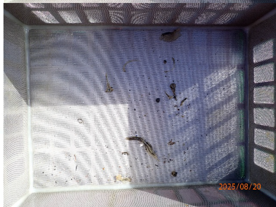
Prøvestasjon 9: Litt silt, sand og grus. Grå og luktfri prøve med fast konsistens.
