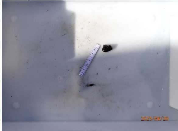
Prøvestasjon 9: Litt silt, sand og grus. Grå og luktfri prøve med fast konsistens.
