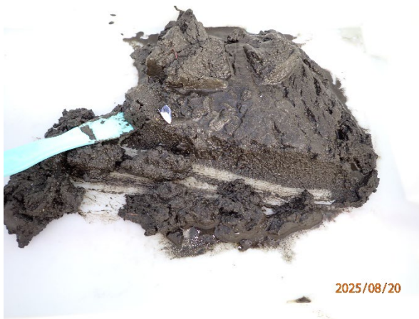
Prøvestasjon 7: Silt, sand og grus. Brun farge men luktfri prøve med mjuk konsistens.
