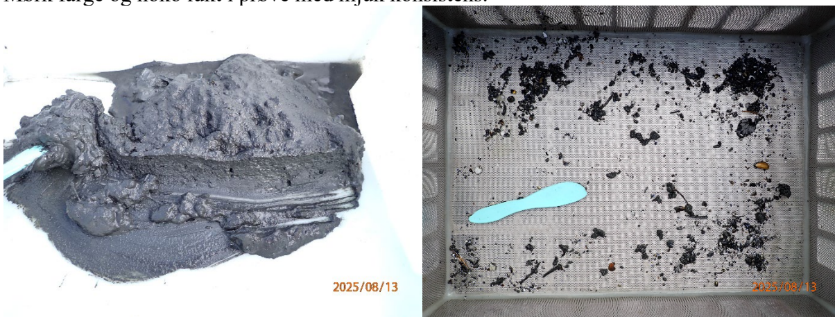
Prøvestasjon 12: Silt, leire og litt sand og grus. Mørk farge og noko lukt i prøve med mjuk konsistens.
