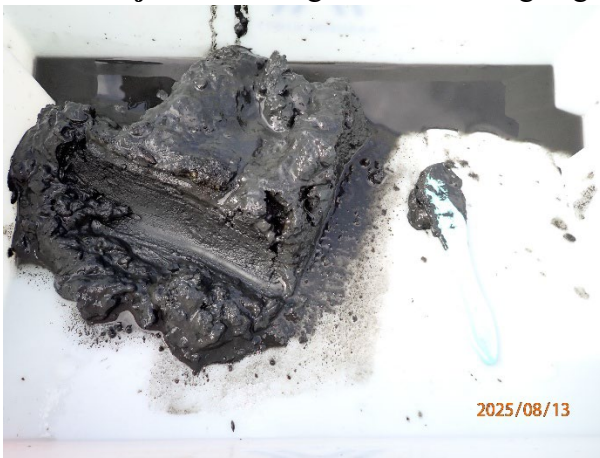
Prøvestasjon 14: Silt og leire. Mørk farge og noko lukt i prøve med mjuk konsistens.
