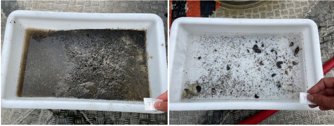
Figur 4: Bilder som viser sedimentet fra stasjon 4 før og etter siling. Sedimentet besto av silt og noe skjellsand. Det ble registrert rester av fôr og fekalier i prøven. Foto: Aqua Kompetanse AS.
