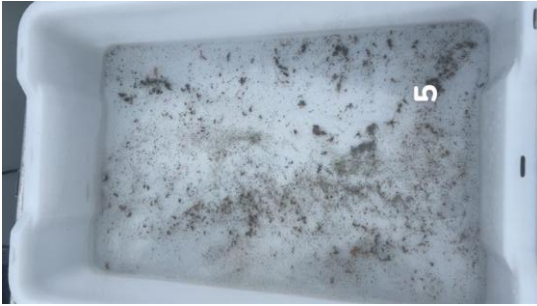
Figur B.5: Bilde fra stasjon 5. Sedimentet besto av strø av sand på fjellbunn. Det ble registrert fekalier i denne prøven. Kilde OceanPro AS.
