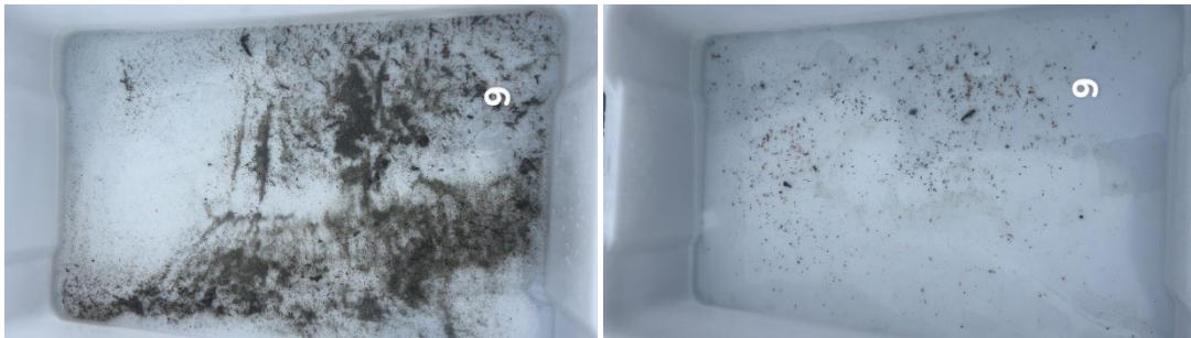
Figur B.9: Bilder før og etter siling ved stasjon 9. Sedimentet besto av sand på fjellbunn. Kilde OceanPro AS.
