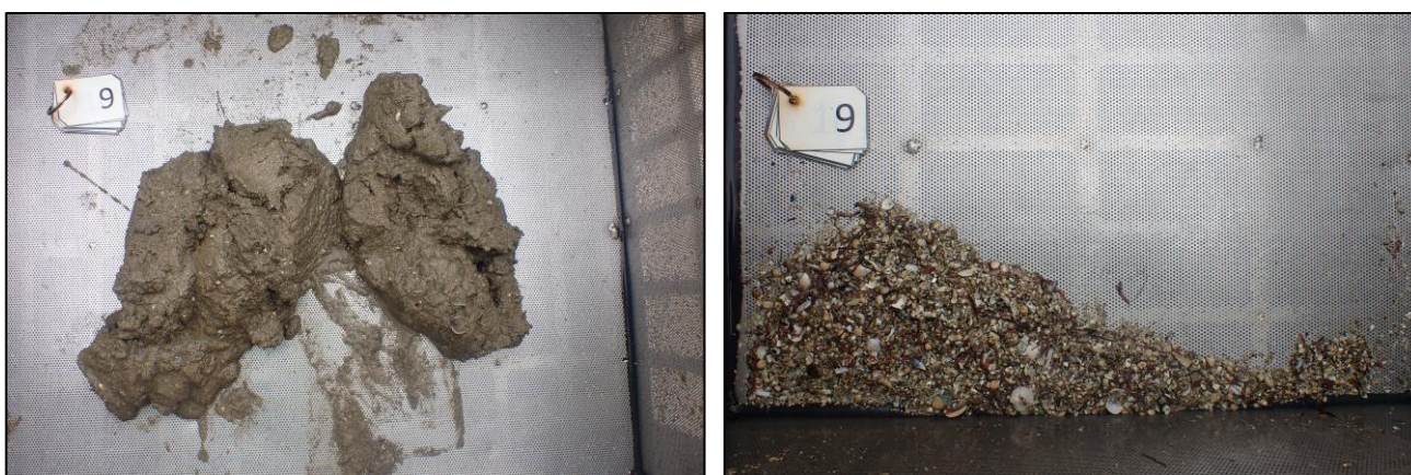
Figur 15. Bilder av sedimentet hentet opp fra prøvepunkt 9. Uvasket prøve til venstre og vasket/silt prøve til høyre.
