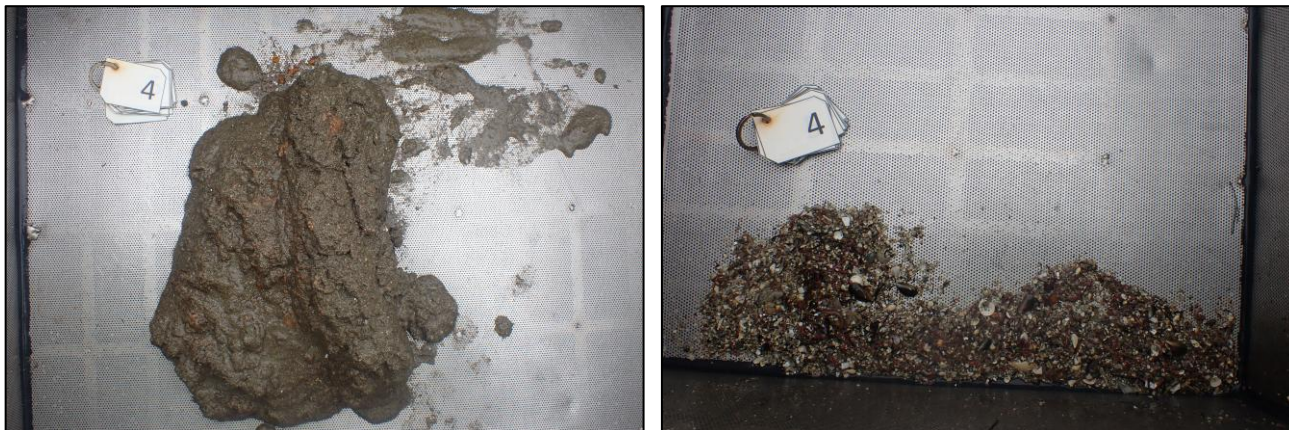
Figur 10. Bilder av sedimentet hentet opp fra prøvepunkt 4. Uvasket prøve til venstre og vasket/silt prøve til høyre.
