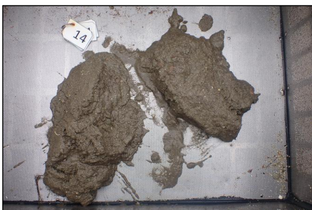
Figur 20. Bilder av sedimentet hentet opp fra prøvepunkt 14. Uvasket prøve til venstre og vasket/silt prøve til høyre.
