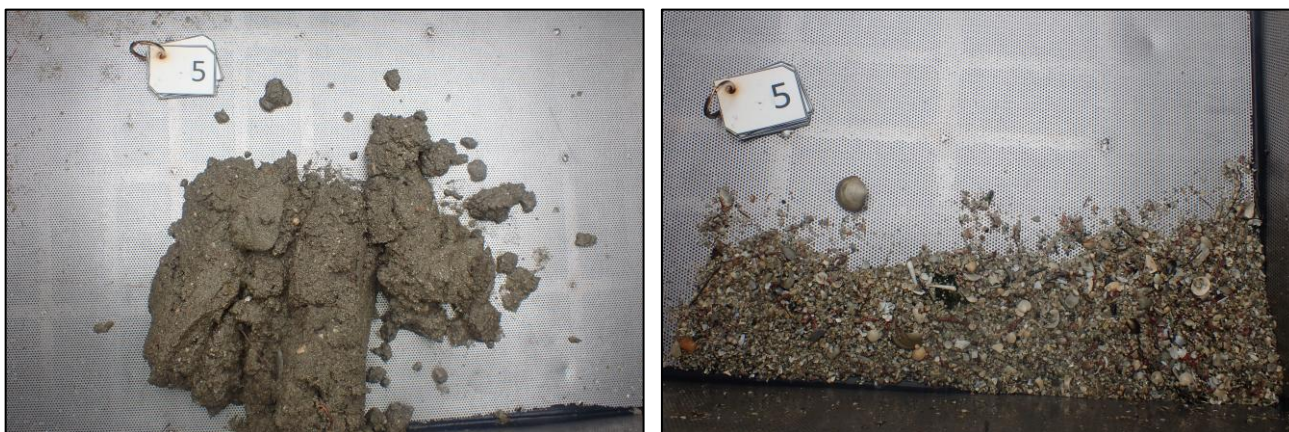
Figur 11. Bilder av sedimentet hentet opp fra prøvepunkt 5. Uvasket prøve til venstre og vasket/silt prøve til høyre.
