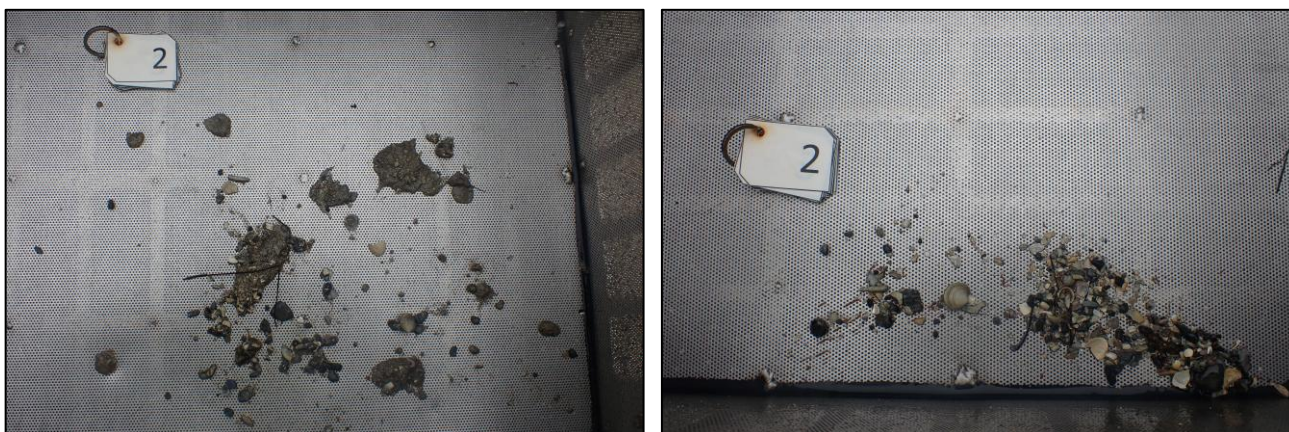
Figur 8. Bilder av sedimentet hentet opp fra prøvepunkt 2. Uvasket prøve til venstre og vasket/silt prøve til høyre.
