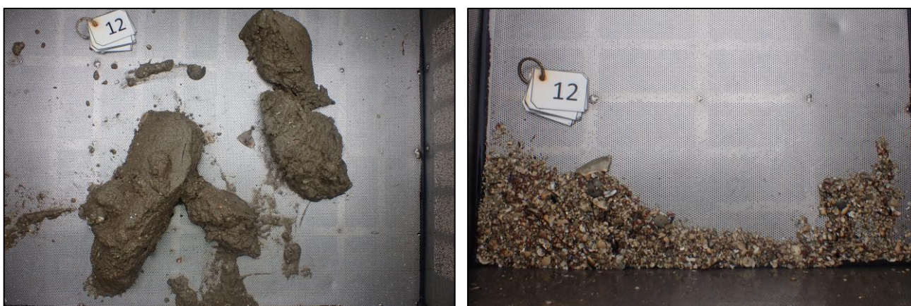
Figur 18. Bilder av sedimentet hentet opp fra prøvepunkt 12. Uvasket prøve til venstre og vasket/silt prøve til høyre.
