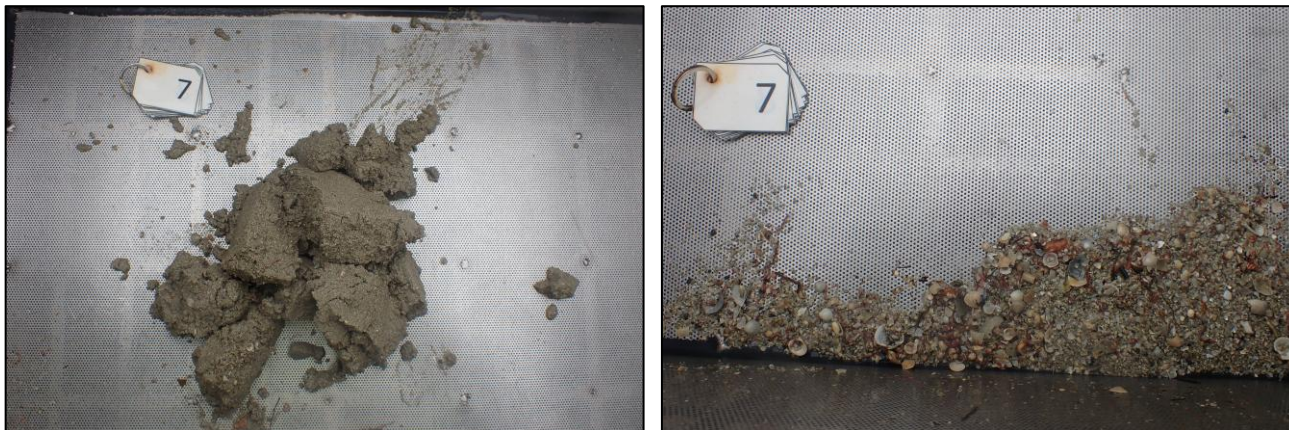
Figur 13. Bilder av sedimentet hentet opp fra prøvepunkt 7. Uvasket prøve til venstre og vasket/silt prøve til høyre.
