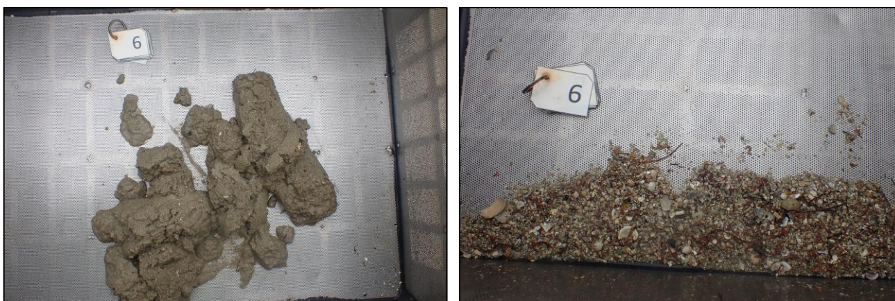
Figur 12. Bilder av sedimentet hentet opp fra prøvepunkt 6. Uvasket prøve til venstre og vasket/silt prøve til høyre.
