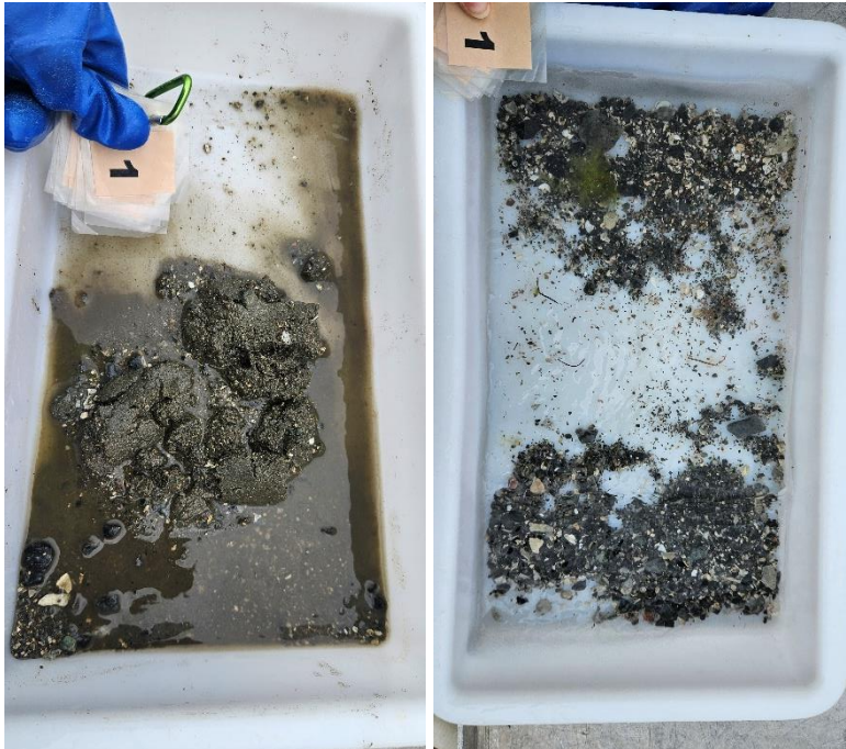
Figur 1: Bilder som viser sedimentet fra stasjon 1 før og etter siling. Sedimentet besto av grus, sand, og skjellsand. Det ble også registrert fjellbunn. Foto: Aqua Kompetanse AS.
