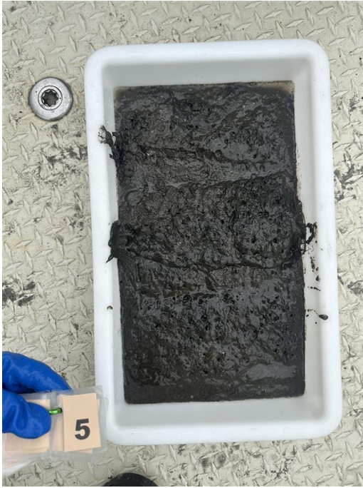
Figur 5: Bilde som viser sedimentet fra stasjon 5 før siling. Det ble ikke tatt bilde etter siling grunnet gass. Sedimentet besto av silt og sand. Foto: Aqua Kompetanse AS.
