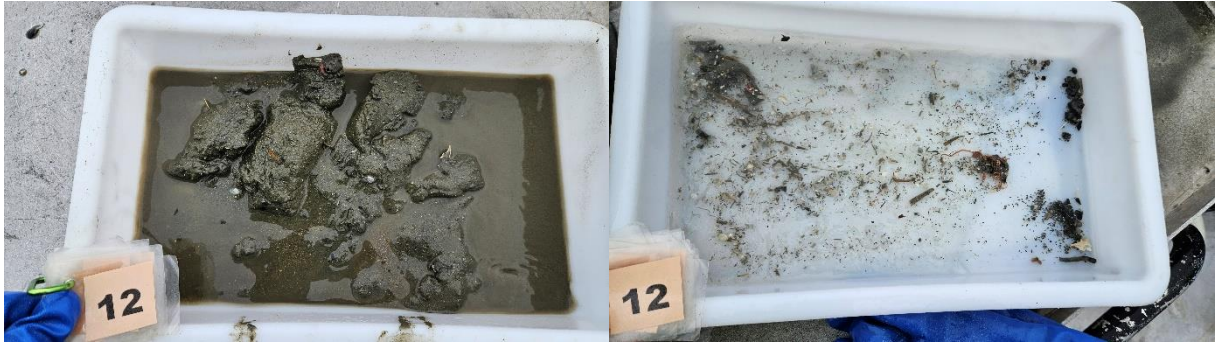
Figur 12: Bilde som viser sedimentet fra stasjon 12 før og etter siling. Sedimentet besto av silt, sand og grus. Foto: Aqua Kompetanse AS.
