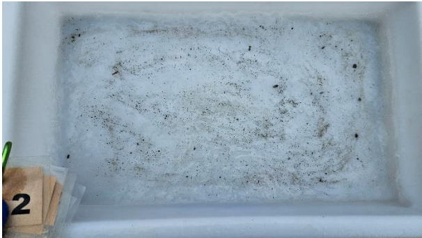
Figur 2: Bilder som viser sedimentet fra stasjon 2. Sedimentet besto av sand, over fjellbunn. Foto: Aqua Kompetanse AS.
