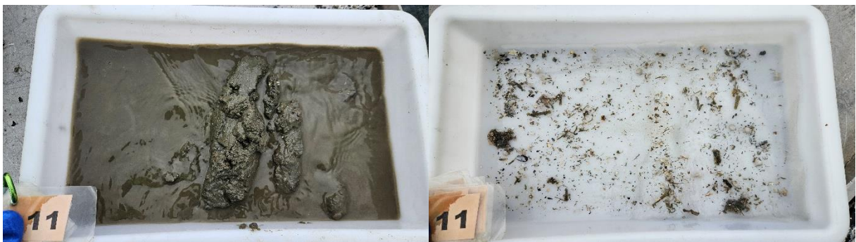
Figur 11: Bilde som viser sedimentet fra stasjon 11 før og etter siling. Sedimentet besto av silt og sand. Foto: Aqua Kompetanse AS.
