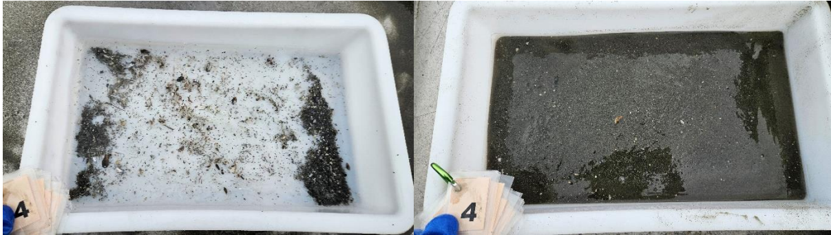
Figur 4: Bilder som viser sedimentet fra stasjon 4 før og etter siling. Sedimentet besto av silt, sand og grus. Foto: Aqua Kompetanse AS.
