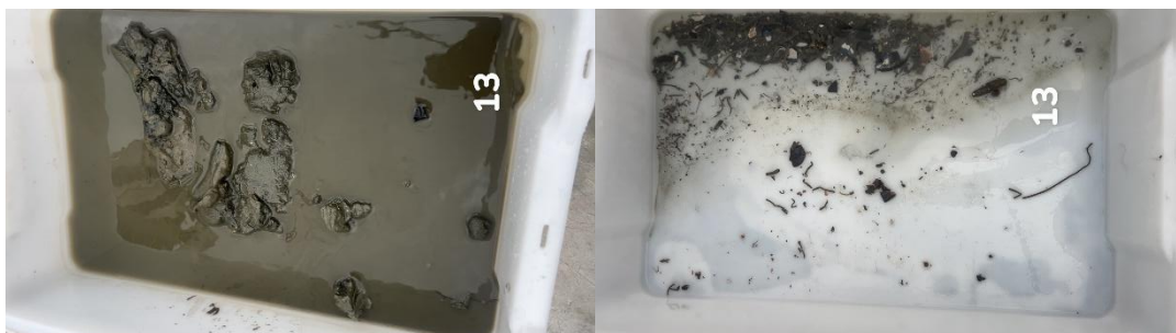
Figur B.13: Bilder før og etter siling ved stasjon 13. Sedimentet besto av leire og silt.
