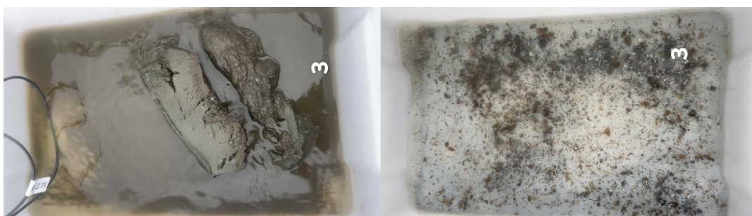
Figur B.3: Bilder før og etter siling ved stasjon 3. Sedimentet besto av leire og silt.
