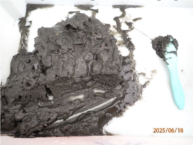
Prøvestasjon 9: Silt og leire. Mørk farge og sterk lukt i prøve med mjuk konsistens.
