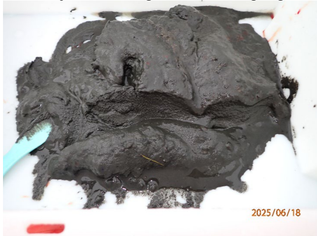
Prøvestasjon 13: Silt og leire. Mørk farge og sterk lukt i prøve med laus konsistens.
