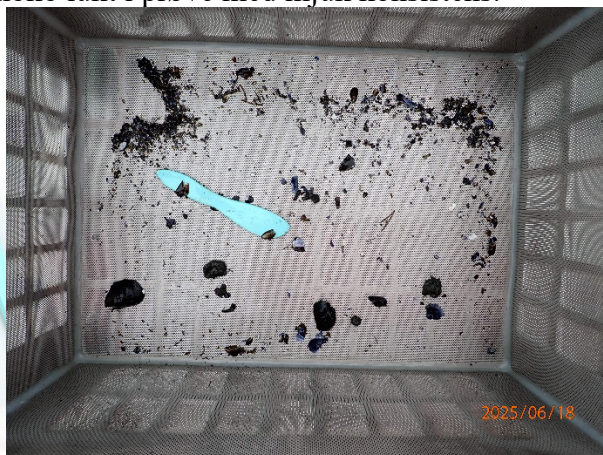
Prøvestasjon 14: Silt og leire. Mørk farge og noko lukt i prøve med mjuk konsistens.
