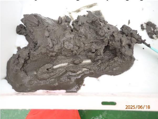
Prøvestasjon 8: Silt og leire. Lys farge og lukt fri prøve med mjuk konsistens.
