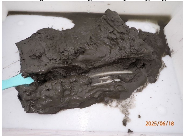
Prøvestasjon 4: Silt og leire. Lys farge og lukt fri prøve med mjuk konsistens.
