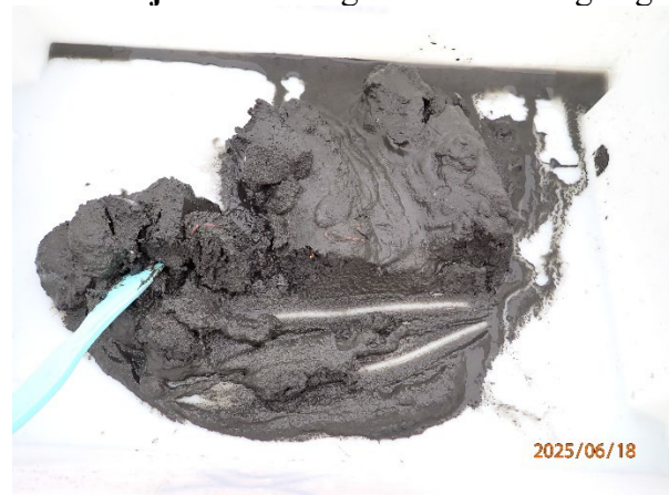
Prøvestasjon 12: Silt og leire. Mørk farge og noko lukt i prøve med mjuk konsistens.
