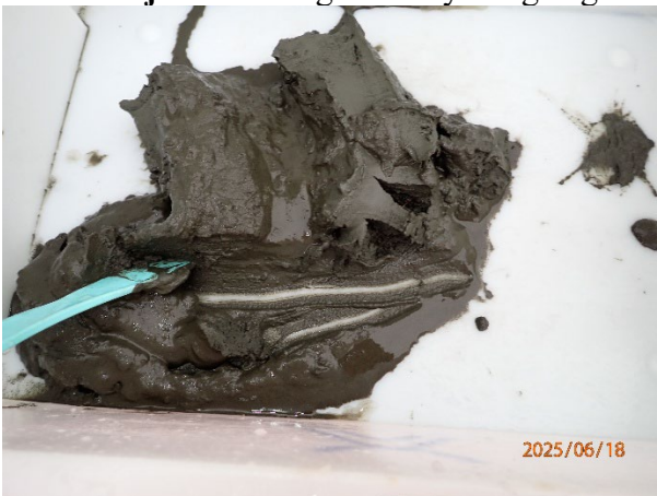
Prøvestasjon 6: Silt og leire. Lys farge og lukt fri prøve med mjuk konsistens.
