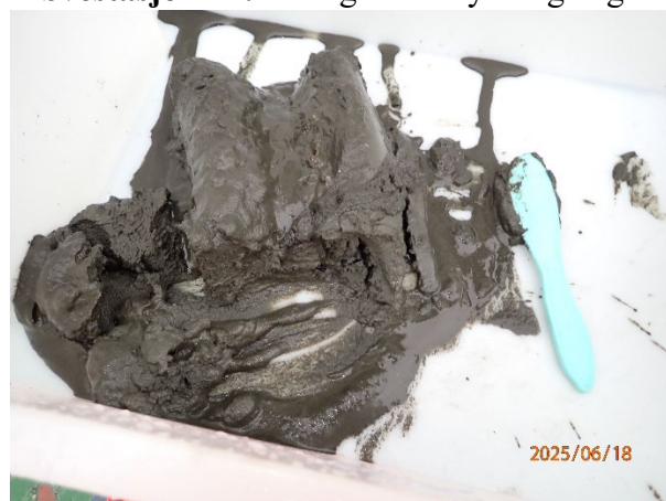
Prøvestasjon 11: Silt og leire. Lys farge og lukt fri prøve med mjuk konsistens.
