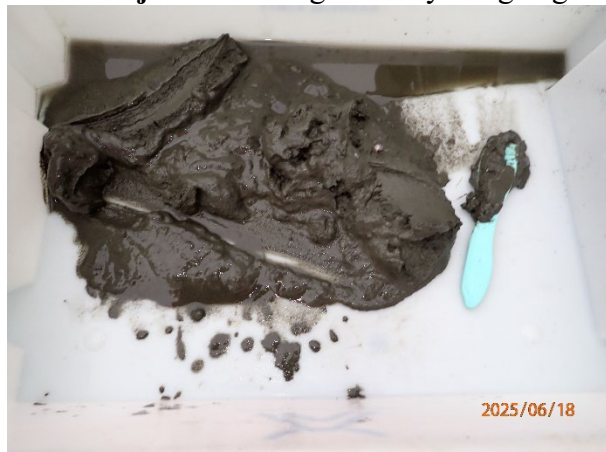
Prøvestasjon 15: Silt og leire. Lys farge og lukt fri prøve med mjuk konsistens.
