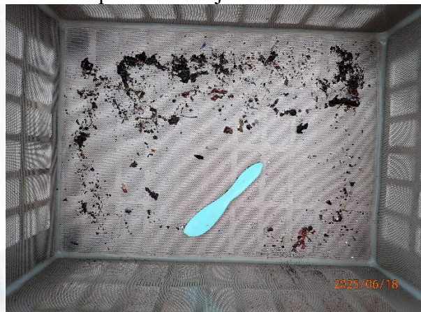
Prøvestasjon 12: Silt og leire. Mørk farge og noko lukt i prøve med mjuk konsistens.
