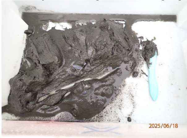
Prøvestasjon 10: Silt og leire. Mørk farge og noko lukt i prøve med mjuk konsistens.
