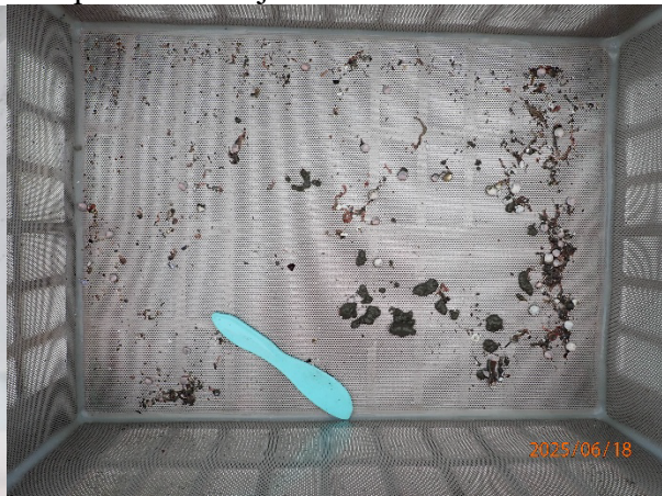
Prøvestasjon 15: Silt og leire. Lys farge og lukt fri prøve med mjuk konsistens.
