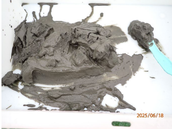
Prøvestasjon 7: Silt og leire. Lys farge og lukt fri prøve med mjuk konsistens.
