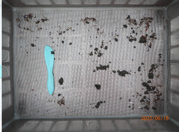
Prøvestasjon 7: Silt og leire. Lys farge og lukt fri prøve med mjuk konsistens.
