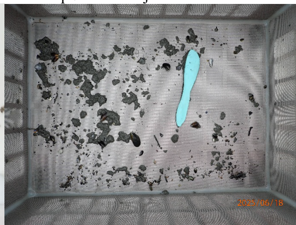
Prøvestasjon 5: Silt og leire. Mørk farge og sterk lukt i prøve med mjuk konsistens.
