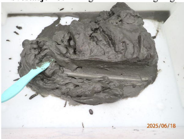
Prøvestasjon 5: Silt og leire. Mørk farge og sterk lukt i prøve med mjuk konsistens.
