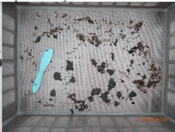
Prøvestasjon 6: Silt og leire. Lys farge og lukt fri prøve med mjuk konsistens.
