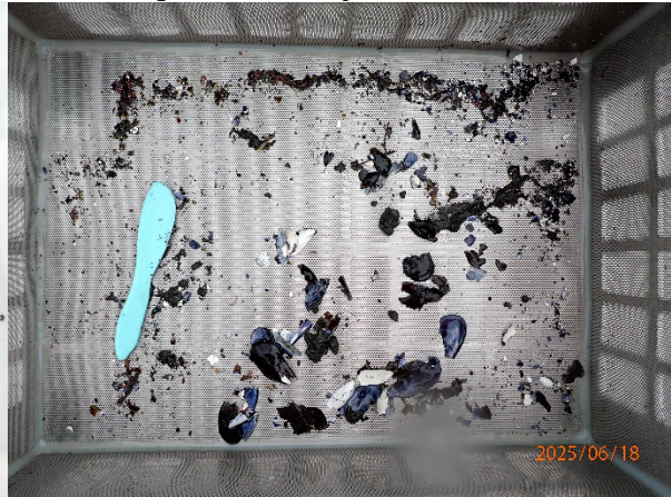
Prøvestasjon 10: Silt og leire. Mørk farge og noko lukt i prøve med mjuk konsistens.
