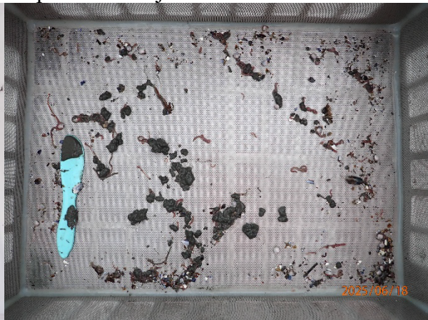
Prøvestasjon 4: Silt og leire. Lys farge og lukt fri prøve med mjuk konsistens.
