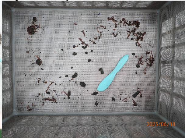
Prøvestasjon 8: Silt og leire. Lys farge og lukt fri prøve med mjuk konsistens.
