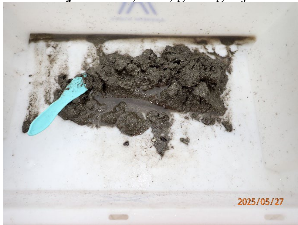
Prøvestasjon 5: Silt, sand, grus og skjelsand. Grå og luktfri prøve med fast konsistens.
