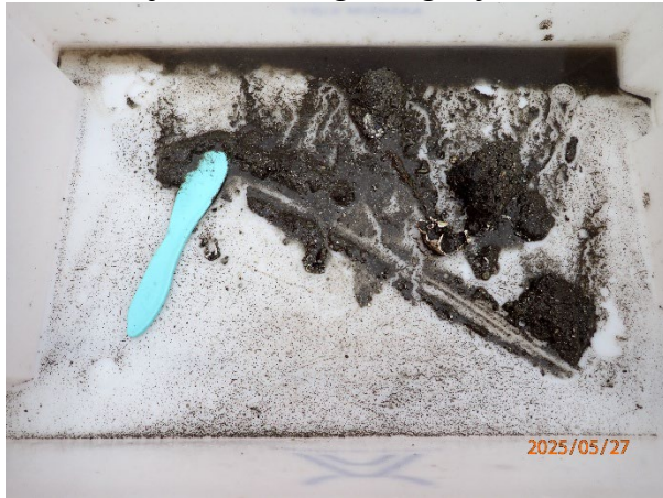
Prøvestasjon 4: Sand, grus og skjelsand. Grå og luktfri prøve med fast konsistens.
