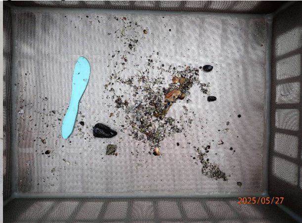
Prøvestasjon 4: Sand, grus og skjelsand. Grå og luktfri prøve med fast konsistens.
