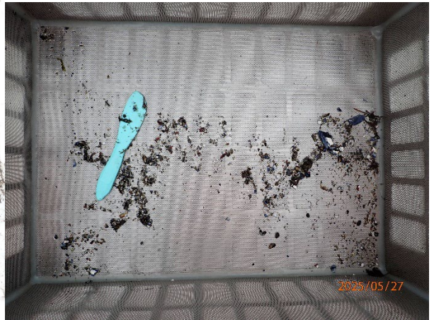
Prøvestasjon 8: Silt, sand og litt grus og skjelsand. Grå og luktfri prøve med mjuk konsistens.
