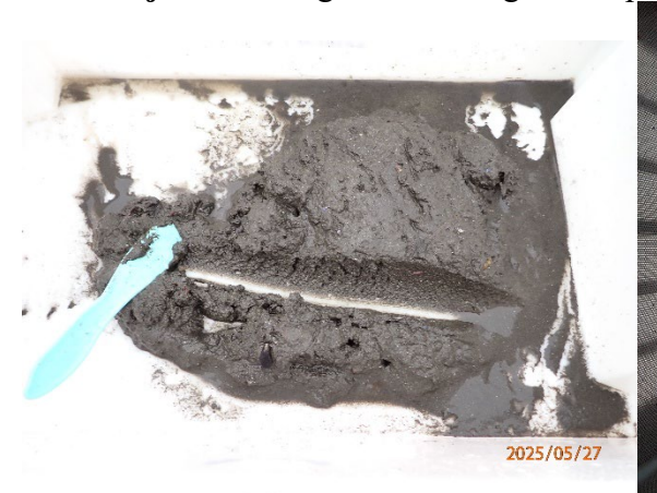
Prøvestasjon 9: Silt og sand. Grå og luktfri prøve med mjuk konsistens.
