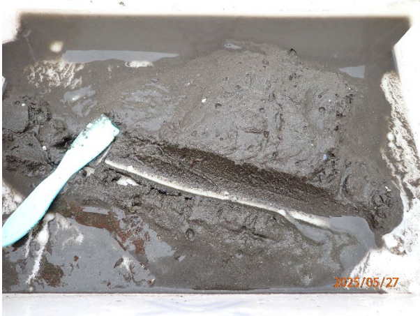
Prøvestasjon 8: Silt, sand og litt grus og skjelsand. Grå og luktfri prøve med mjuk konsistens.
