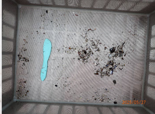
Prøvestasjon 7: Silt, sand og litt grus og skjelsand. Grå og luktfri prøve med mjuk konsistens.
