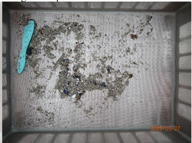
Prøvestasjon 5: Silt, sand, grus og skjelsand. Grå og luktfri prøve med fast konsistens.
