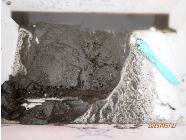
Prøvestasjon 7: Silt, sand og litt grus og skjelsand. Grå og luktfri prøve med mjuk konsistens.
