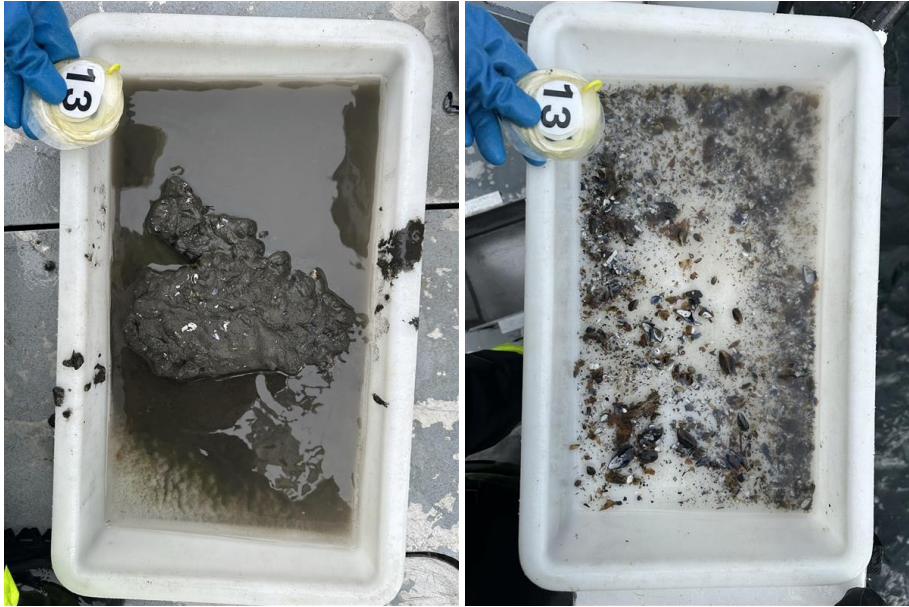
Figur 13: Bilder som viser sedimentet fra stasjon 13 før og etter siling. Sedimentet bestod av silt og sand. Foto: Aqua Kompetanse AS.
