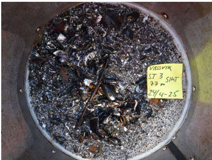
Figur 12 Sedimentprøve fra stasjon 3, 77 meters dyp, siktet
