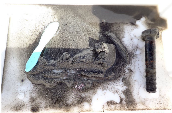
Prøvestasjon 10: Silt og sand. Mørk farge men luktfri prøve med mjuk konsistens.
