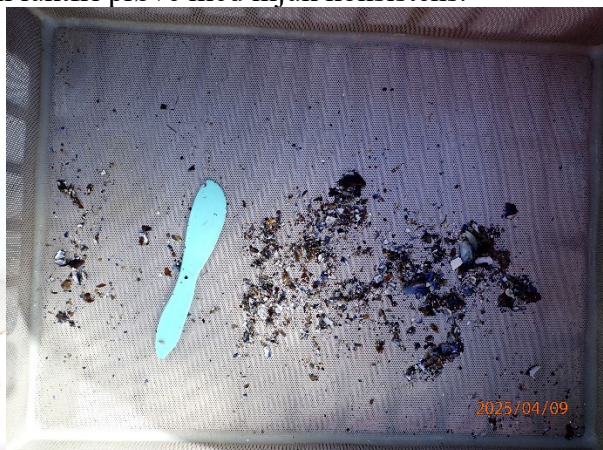
Prøvestasjon 12: Silt og sand. Mørk farge men luktfri prøve med mjuk konsistens.
