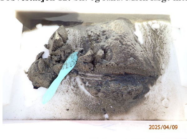
Prøvestasjon 12: Silt og sand. Mørk farge men luktfri prøve med mjuk konsistens.
