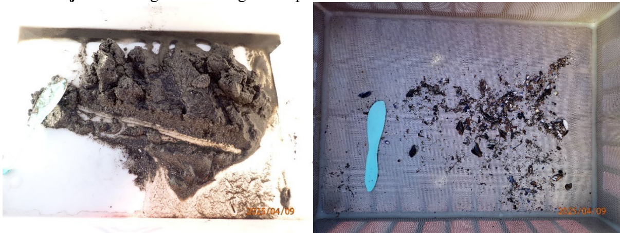
Prøvestasjon 5: Silt og sand. Grå og luktfri prøve med fast konsistens.
