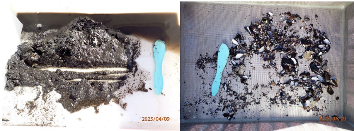
Prøvestasjon 8: Silt og sand. Mørk farge men luktfri prøve med mjuk konsistens.
