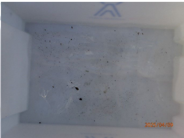
Prøvestasjon 12: Silt og sand. Mørk farge men luktfri prøve med mjuk konsistens.
