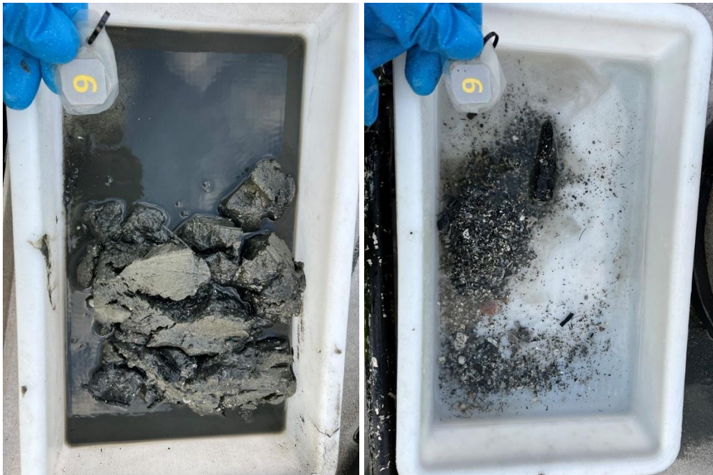
Figur 6: Bilder som viser sedimentet fra stasjon 6 før og etter siling. Sedimentet besto av silt, og noe grus og skjellsand. Foto: Aqua Kompetanse AS.
