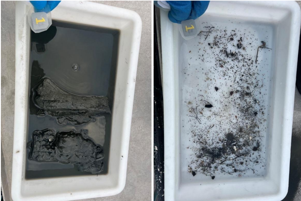
Figur 1: Bilder som viser sedimentet fra stasjon 1 før og etter siling. Sedimentet besto av silt, og noe skjellsand. Foto: Aqua Kompetanse AS.
