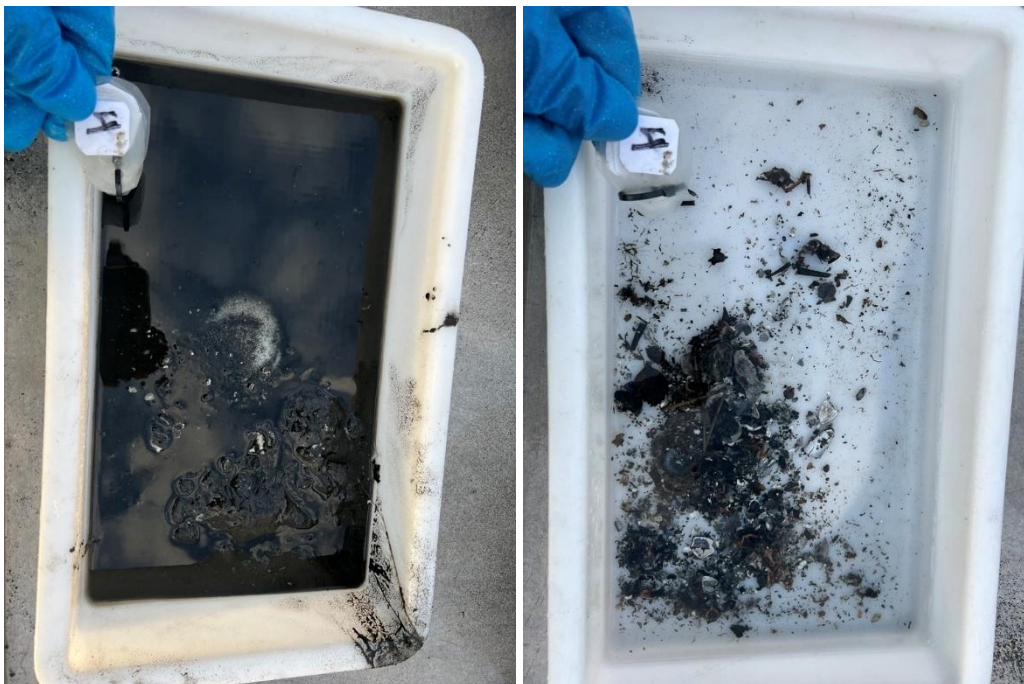
Figur 4: Bilder som viser sedimentet fra stasjon 4 før og etter siling. Sedimentet besto av silt, og noe leire og grus. Foto: Aqua Kompetanse AS.
