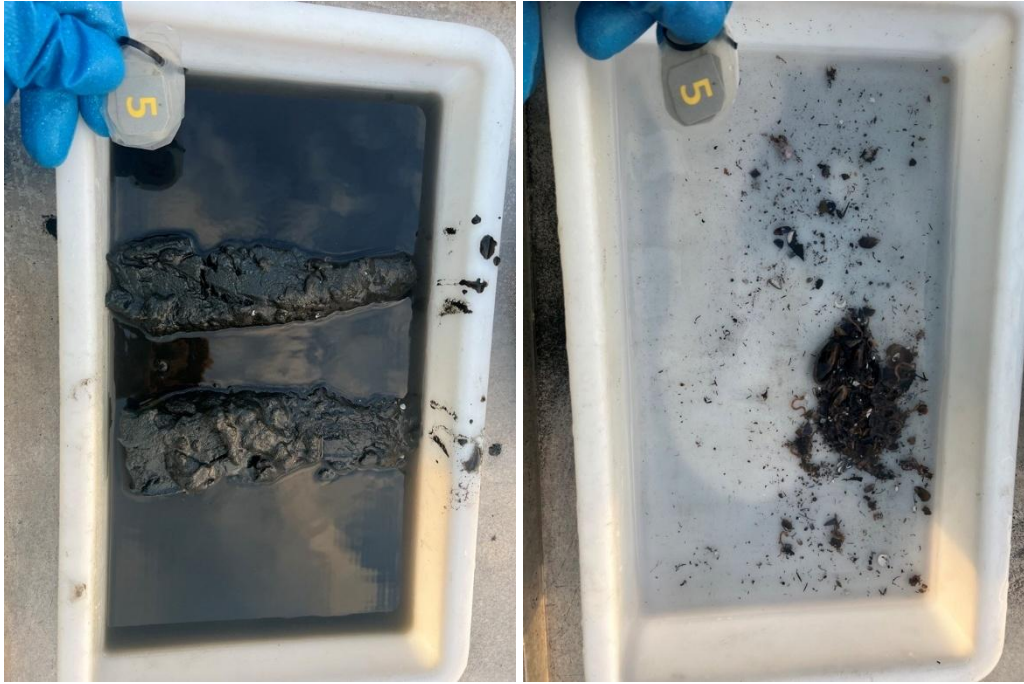
Figur 5: Bilder som viser sedimentet fra stasjon 5 før og etter siling. Sedimentet besto av silt, noe grus. Foto: Aqua Kompetanse AS.
