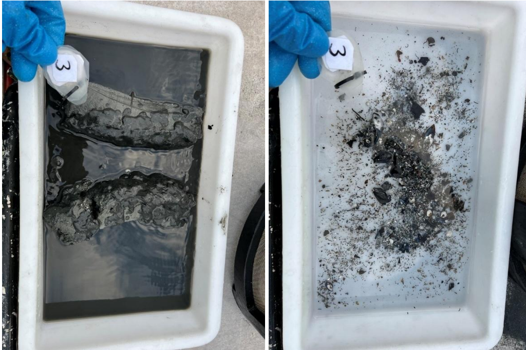
Figur 3: Bilder som viser sedimentet fra stasjon 3 før og etter siling. Sedimentet besto av silt, og noe skjellsand. Foto: Aqua Kompetanse AS.
