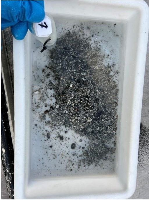
Figur 7: Bilde som viser sedimentet fra stasjon 7. Sedimentet besto av strø av grus på fjellbunn. Foto: Aqua Kompetanse AS.
