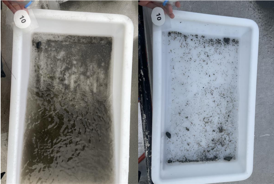
Figur 10: Bilder som viser sedimentet fra stasjon 10 før og etter siling. Sedimentet besto av grus over fjellbunn. Foto: Aqua Kompetanse AS.
