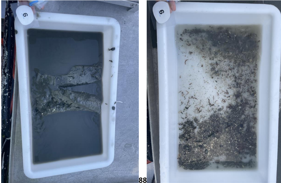
Figur 6: Bilde som viser sedimentet fra stasjon 6 før og etter siling. Sedimentet besto av leire, sand og grus. Foto: Aqua Kompetanse AS.
