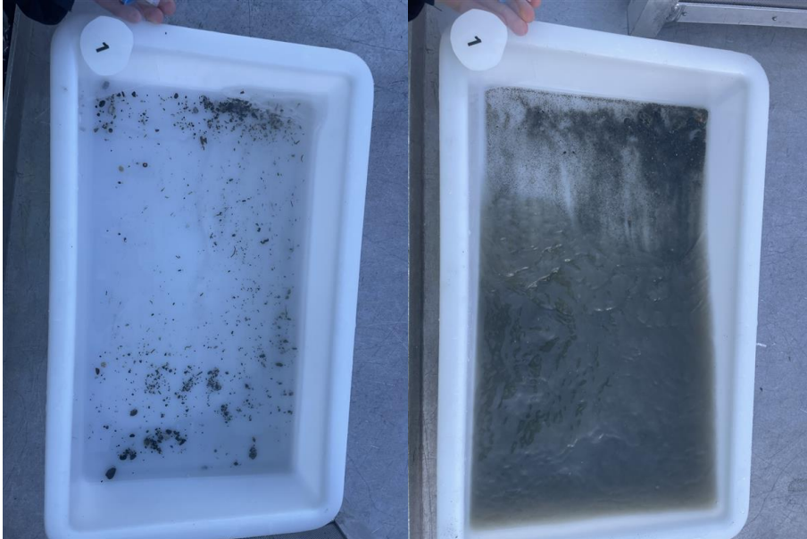
Figur 1: Bilder som viser sedimentet fra stasjon 1 før og etter siling. Sedimentet besto av silt og grus over fjellbunn. Foto: Aqua Kompetanse AS.
