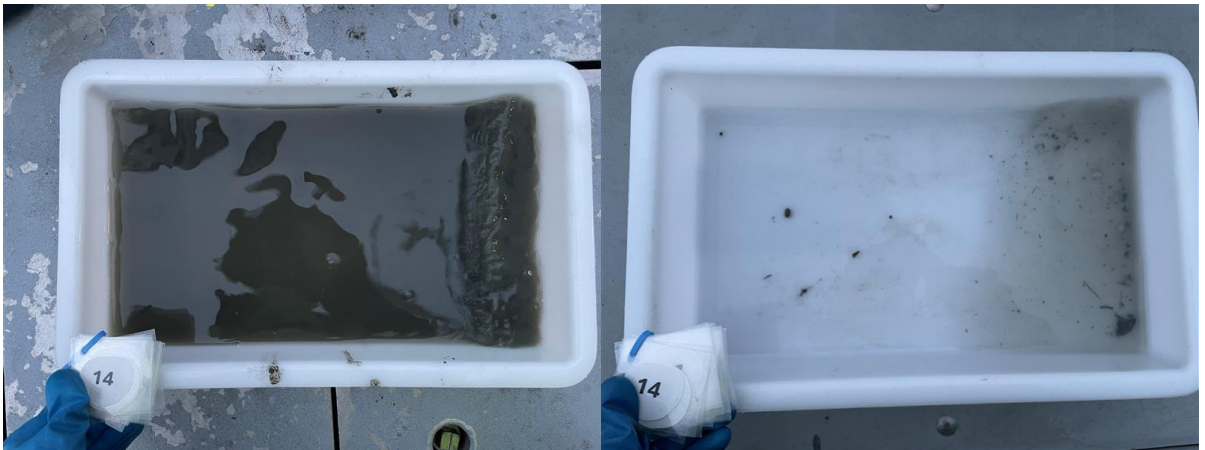
Figur 13: Bilder som viser sedimentet fra stasjon 14 før og etter siling. Sedimentet besto av silt. Det ble også registrert fjellbunn. Foto: Aqua Kompetanse AS.
