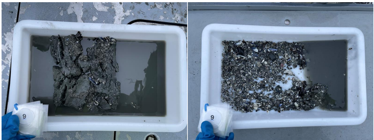
Figur 8: Bilder som viser sedimentet fra stasjon 9 før og etter siling. Sedimentet besto av leire, silt og skjellsand. Foto: Aqua Kompetanse AS.
