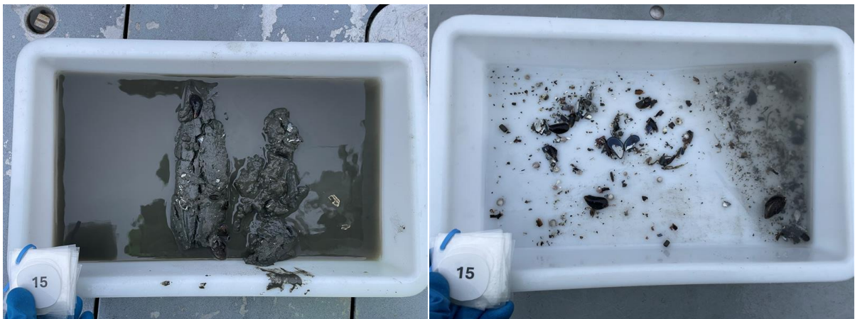
Figur 14: Bilder som viser sedimentet fra stasjon 15 før og etter siling. Sedimentet besto av leire og silt. Foto: Aqua Kompetanse AS.
