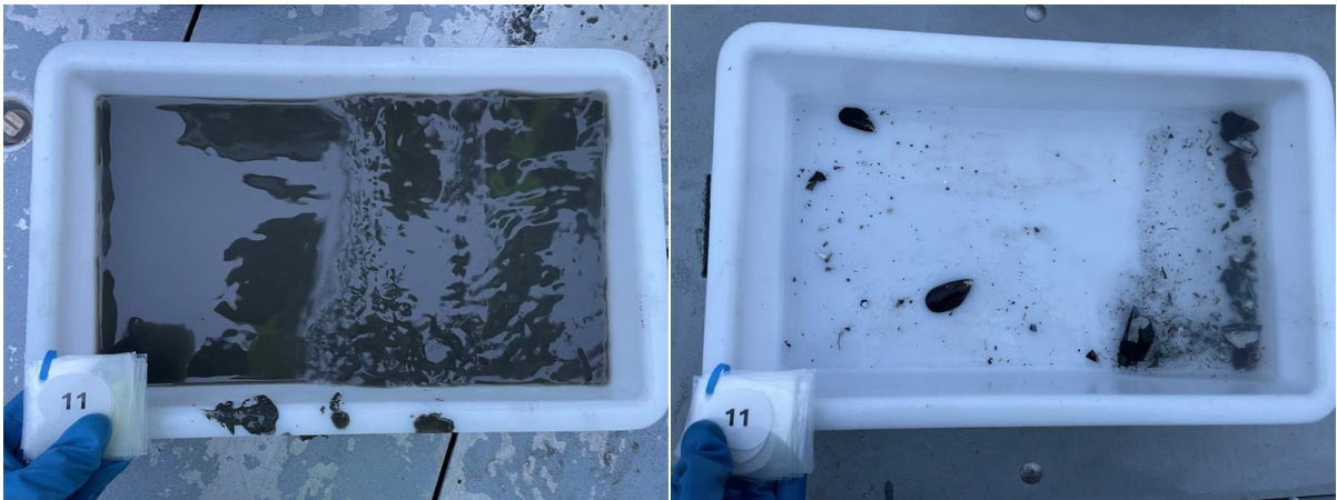
Figur 10: Bilder som viser sedimentet fra stasjon 11 før og etter siling. Sedimentet besto av silt. Det ble også registrert fjellbunn. Foto: Aqua Kompetanse AS.
