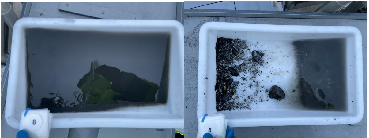
Figur 7: Bilder som viser sedimentet fra stasjon 8 før og etter siling. Sedimentet besto av silt og skjellsand. Foto: Aqua Kompetanse AS.
