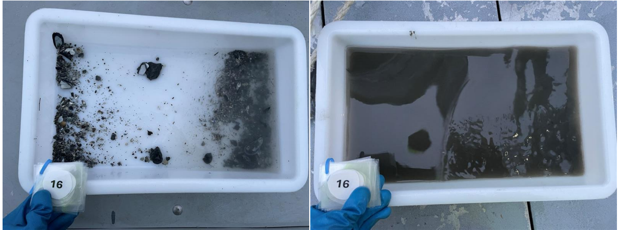
Figur 15: Bilder som viser sedimentet fra stasjon 16 før og etter siling. Sedimentet besto av grus og silt. Det ble også registrert steinbunn. Foto: Aqua Kompetanse AS.
