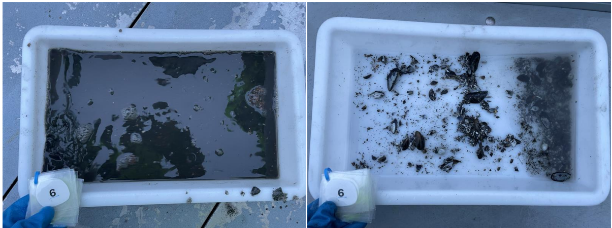
Figur 6: Bilder som viser sedimentet fra stasjon 6 før og etter siling. Sedimentet besto av silt. Det ble registrert fekalier ved stasjonen. Foto: Aqua Kompetanse AS.
