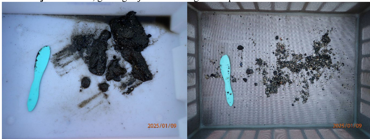
Prøvestasjon 10: Sand, grus og skjelsand. Grå og luktfri prøve med fast konsistens.
