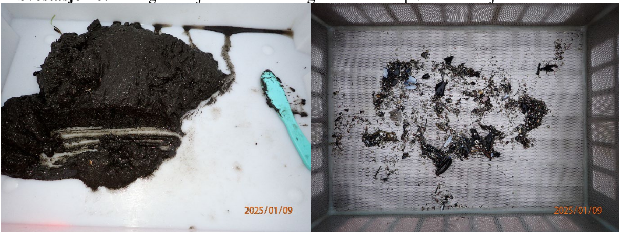
Prøvestasjon 6: Silt og litt skjelsand. Brun farge men luktfri prøve med mjuk konsistens.
