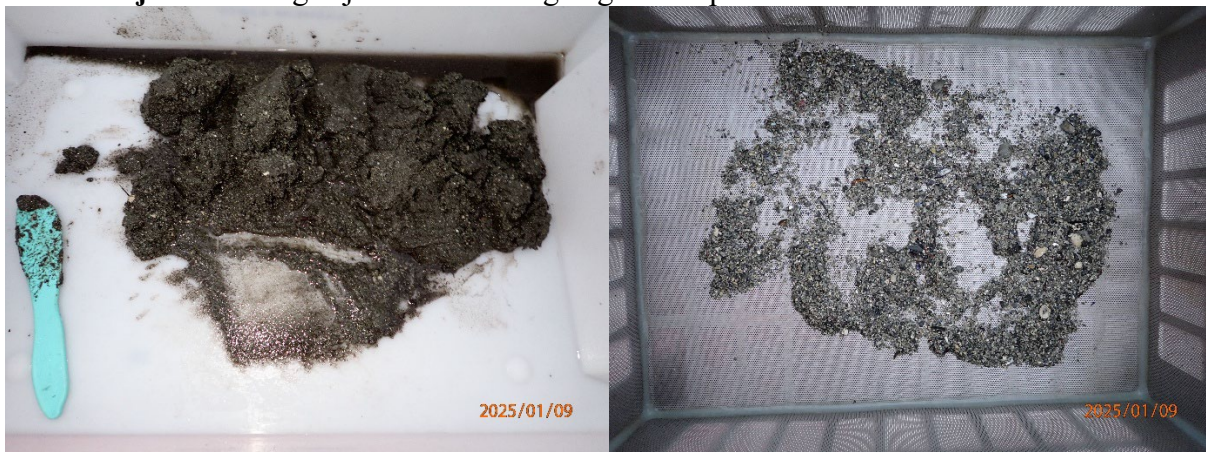
Prøvestasjon 7: Silt og skjelsand. Grå farge og luktfri prøve med fast konsistens.
