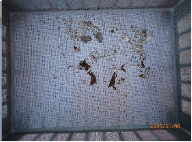
Prøvestasjon 10: Litt grus og skjelsand. Grå og luktfri prøve med fast konsistens.
