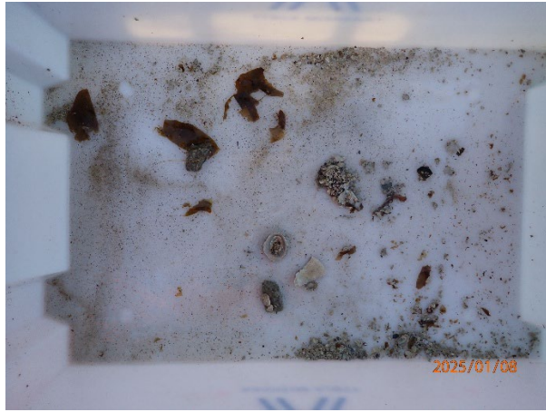
Prøvestasjon 10: Litt grus og skjelsand. Grå og luktfri prøve med fast konsistens.
