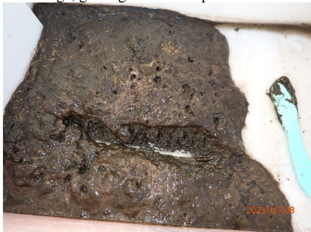
Prøvestasjon 7: Sand og skjelsand med fiske-skit. Brun farge, gass og sterk lukt i prøve med laus konsistens.
