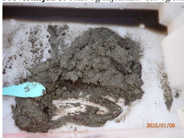
Prøvestasjon 8: Sand og skjelsand. Grå og luktfri prøve med fast konsistens.
