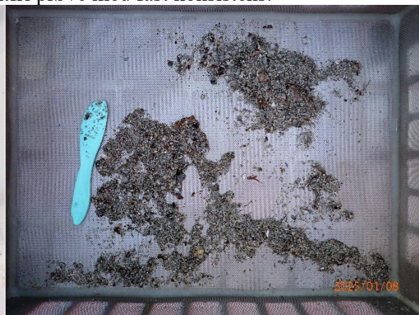
Prøvestasjon 8: Sand og skjelsand. Grå og luktfri prøve med fast konsistens.
