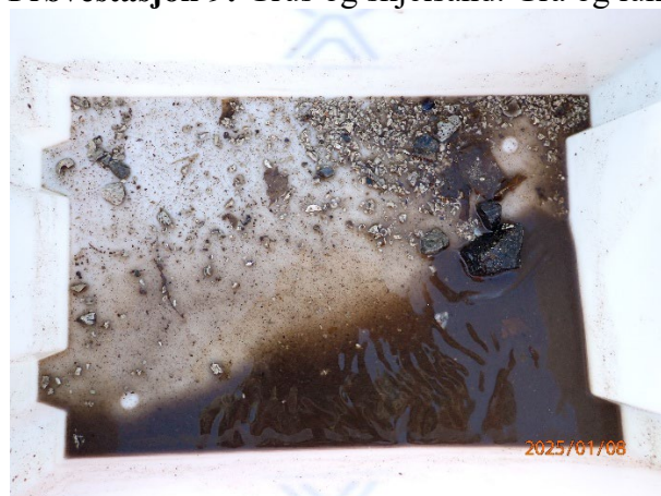
Prøvestasjon 9: Grus og skjelsand. Grå og luktfri prøve med fast konsistens.
