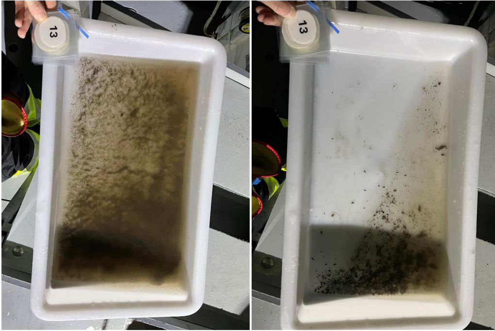
Figur 13: Bilder som viser sedimentet fra stasjon 13 før og etter siling. Sedimentet besto av silt. Det ble også registrert fjellbunn. Foto: Aqua Kompetanse AS.
