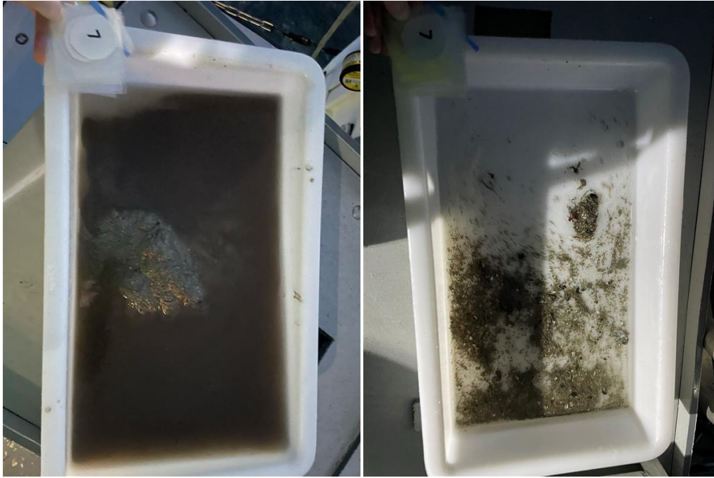
Figur 7: Bilder som viser sedimentet fra stasjon 7 før og etter siling. Sedimentet besto av silt, og noe skjellsand. Foto: Aqua Kompetanse AS.
