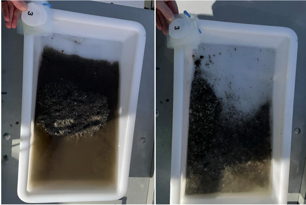
Figur 3: Bilder som viser sedimentet fra stasjon 3 før og etter siling. Sedimentet besto av silt og skjellsand. Foto: Aqua Kompetanse AS.
