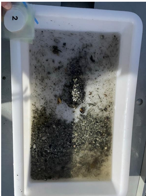
Figur 2: Bilde som viser sedimentet fra stasjon 2 etter siling. Sedimentet besto av silt, og noe skjellsand. Det ble registrert fôr og fekalier i prøven. Bildet før siling mangler. Foto: Aqua Kompetanse AS.
