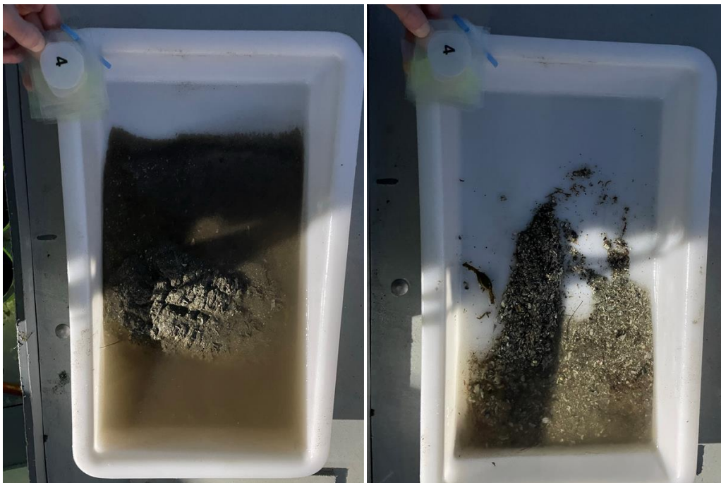
Figur 4: Bilder som viser sedimentet fra stasjon 4 før og etter siling. Sedimentet besto av silt og skjellsand. Foto: Aqua Kompetanse AS.
