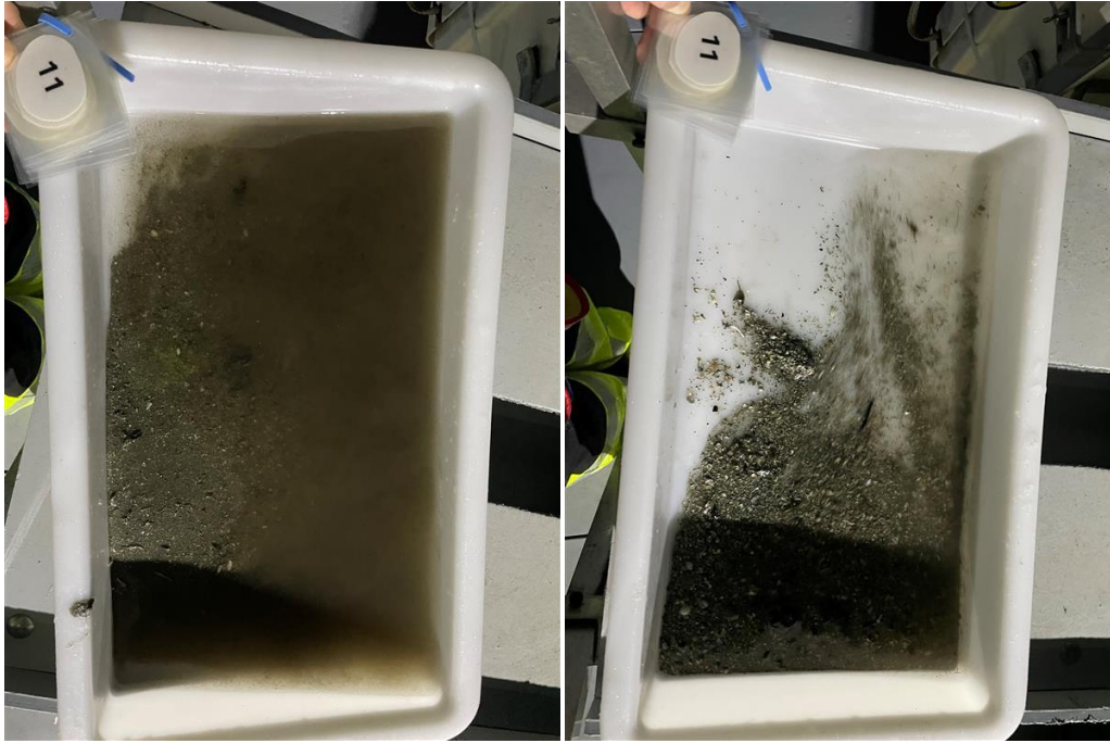
Figur 11: Bilder som viser sedimentet fra stasjon 11 før og etter siling. Sedimentet besto av silt, og noe grus og skjellsand. Foto: Aqua Kompetanse AS.
