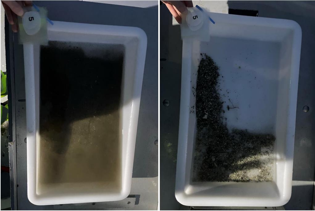
Figur 5: Bilder som viser sedimentet fra stasjon 5 før og etter siling. Sedimentet besto av silt, skjellsand, og noe sand. Foto: Aqua Kompetanse AS.
