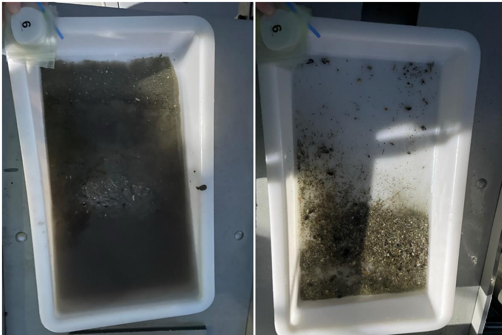
Figur 6: Bilder som viser sedimentet fra stasjon 6 før og etter siling. Sedimentet besto av silt og skjellsand. Foto: Aqua Kompetanse AS.
