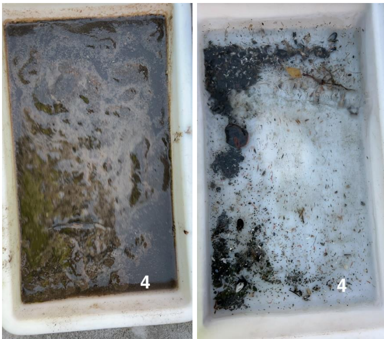
Figur 4: Bilder som viser sedimentet fra stasjon 4 før og etter siling. Sedimentet besto av silt og sand. Det ble registrert rester av fekalier ved stasjonen. Foto: Aqua Kompetanse AS.
