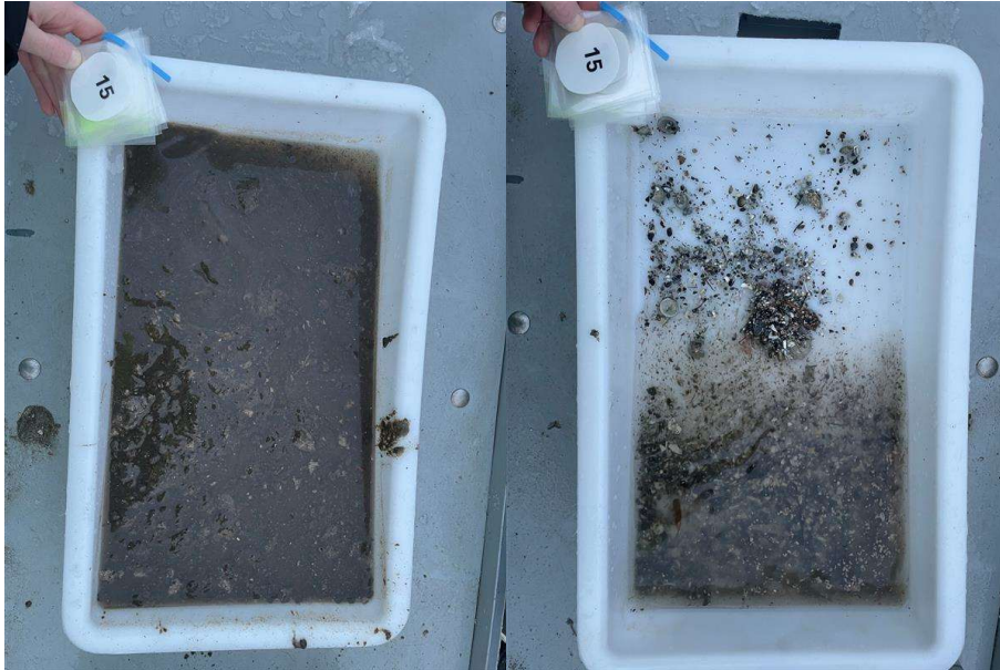
Figur 15: Bilder som viser sedimentet fra stasjon 15 før og etter siling. Sedimentet bestod av silt. Det ble registrert fôr og fekalier ved stasjonen. Foto: Aqua Kompetanse AS.
