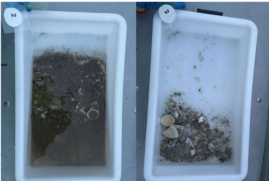
Figur 2: Bilder som viser sedimentet fra stasjon 2 før og etter siling. Sedimentet besto av silt og noe sand. Foto: Aqua Kompetanse AS.
