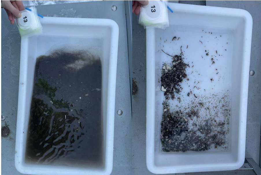
Figur 13: Bilder som viser sedimentet fra stasjon 13 før og etter siling. Sedimentet bestod av silt. Foto: Aqua Kompetanse AS.
