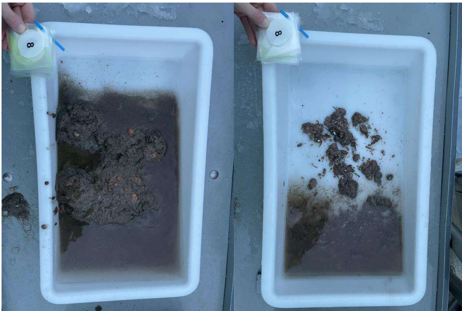
Figur 8: Bilder som viser sedimentet fra stasjon 8 før og etter siling. Sedimentet besto av silt og noe sand. Det ble registrert fôr og fekalier ved stasjonen. Foto: Aqua Kompetanse AS.
