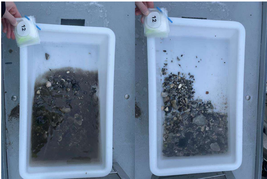
Figur 12: Bilde som viser sedimentet fra stasjon 12 før og etter siling. Sedimentet besto av silt og grus. Det ble også registrert steinbunn ved stasjonen. Foto: Aqua Kompetanse AS.
