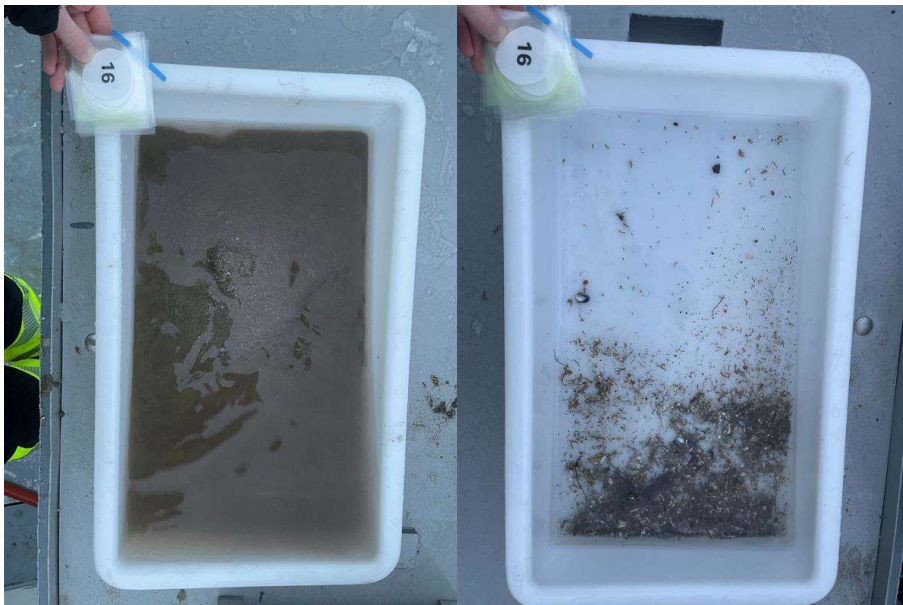
Figur 16: Bilder som viser sedimentet fra stasjon 16 før og etter siling. Sedimentet besto av silt og sand. Foto: Aqua Kompetanse AS.
