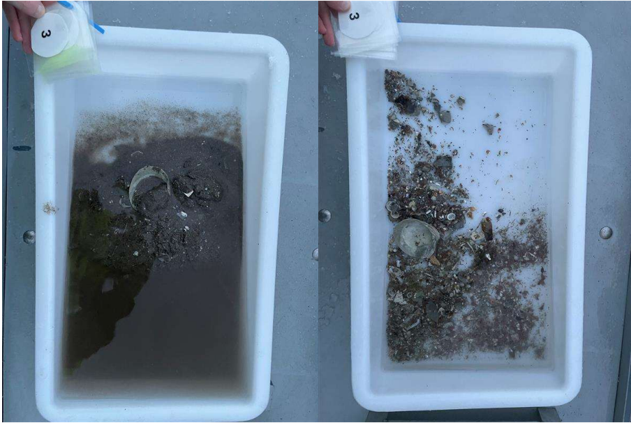
Figur 3: Bilder som viser sedimentet fra stasjon 3 før og etter siling. Sedimentet besto av silt og noe sand. Det ble registrert fekalier ved stasjonen. Foto: Aqua Kompetanse AS.
