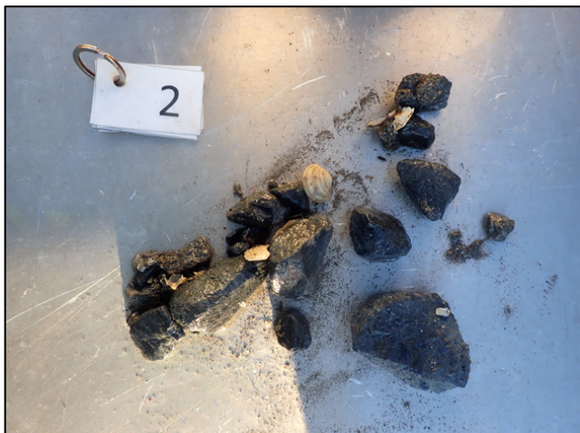
Figur 8. Bilde av sedimentet hentet opp ved prøvepunkt 2. Uvasket prøve til venstre og vasket/silt prøve til høyre.
