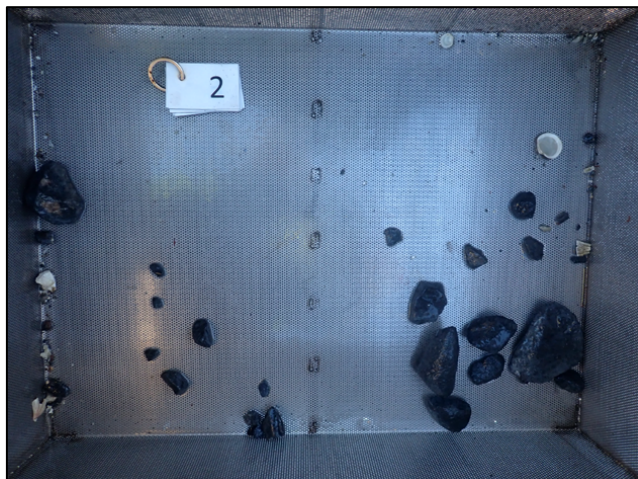
Figur 8. Bilde av sedimentet hentet opp ved prøvepunkt 2. Uvasket prøve til venstre og vasket/silt prøve til høyre.
