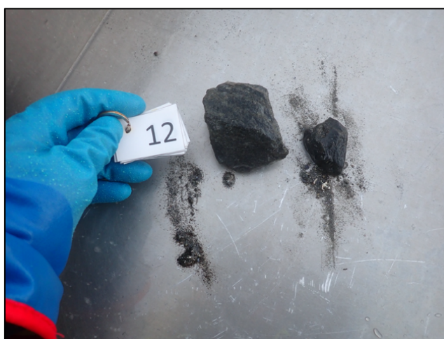
Figur 17. Bilde av sedimentet hentet opp ved prøvepunkt 11. Uvasket prøve til venstre og vasket/silt prøve til høyre.
