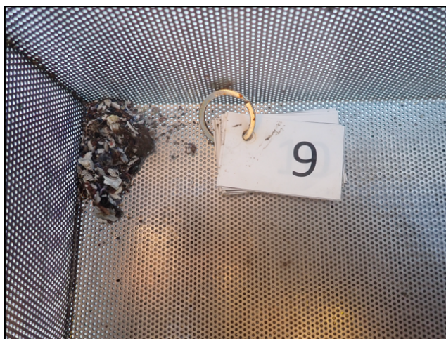
Figur 15. Bilde av sedimentet hentet opp ved prøvepunkt 9. Uvasket prøve til venstre og vasket/silt prøve til høyre.
